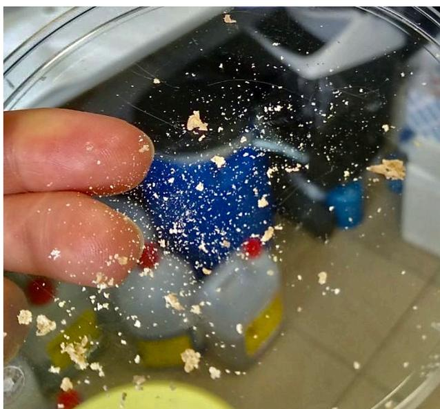
*Figura 47. Intento de síntesis de aerogel a partir de la muestra IN-22 (hidrogel de apoferritina al 1.5 % con adición de NaCl 200 mM previa al tratamiento térmico)*
