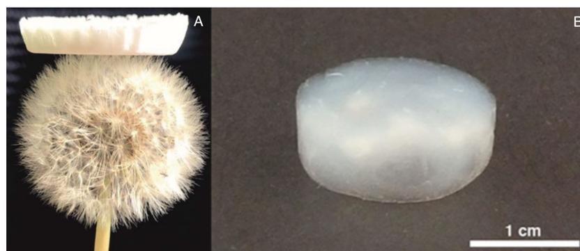
*Figura 52. (A) Aerogel obtenido por liofilización congelando previamente a -196 °C [43]. (B) Aerogel obtenidos por secado con CO<sub>2</sub> supercrítico [32].*
