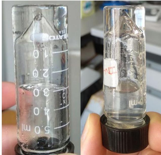
*Figura 13. Comparación entre un hidrogel con buen resultado (izquierda) y un hidrogel con mal resultado (derecha). Ambos hidrogel con concentración 2.5%. Puede apreciarse cómo en la imagen izquierda al invertir el vial el gel queda inmobilizado en la parte superior y el imán usado para la síntesis queda retenido en el gel. En la imagen derecha, por el contrario, el gel cae hacia la parte inferior tras invertir el vial.*
