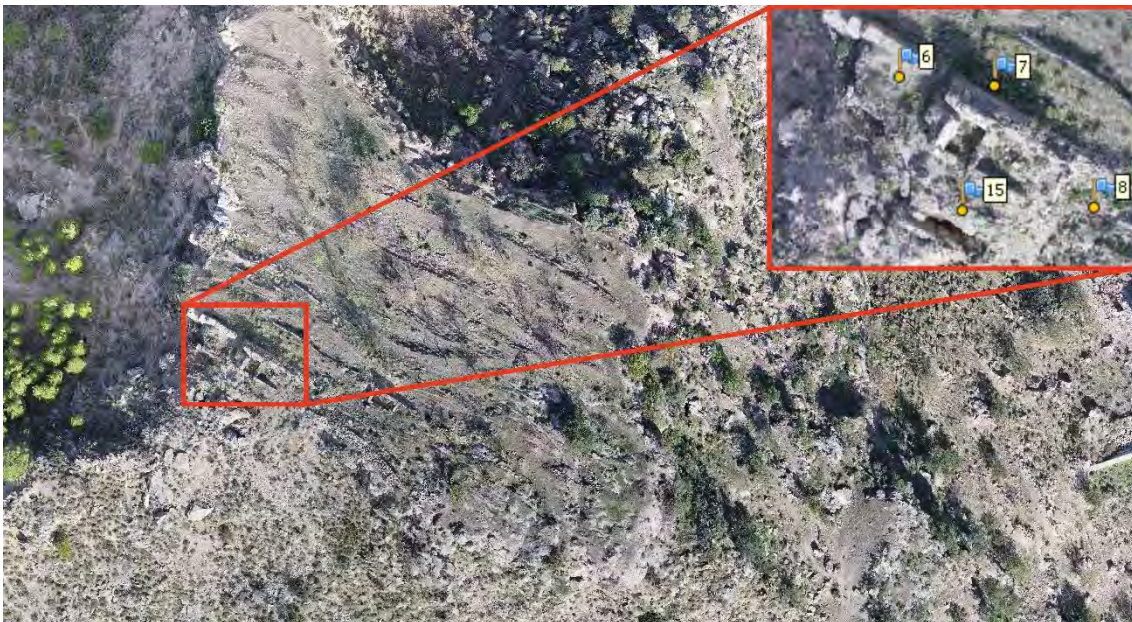
Figura 4. 23: Vista en planta de los puntos de apoyo para la georreferenciación, orientación y escalado del modelo fotogramétrico en el castillejo de Órgiva (Rouco Collazo, Benavides López, et al. 2020).
