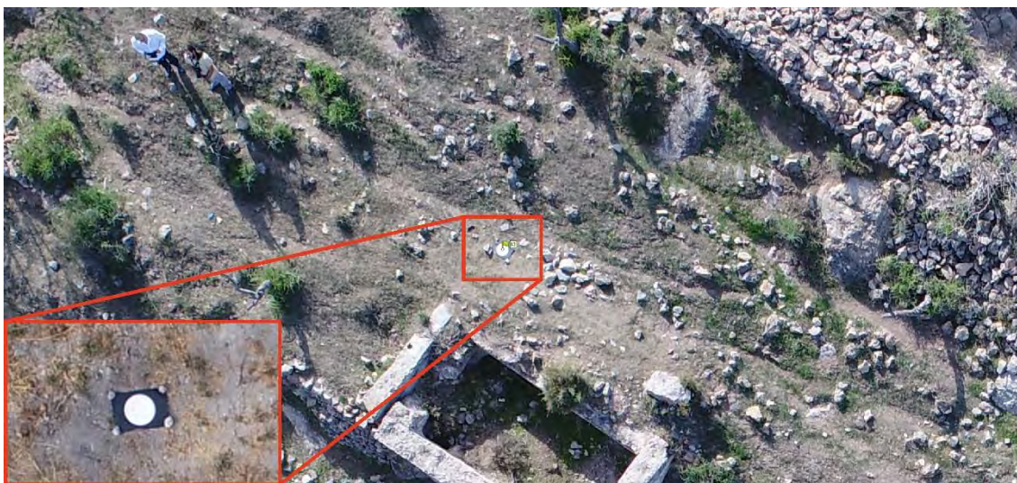
Figura 4. 24: Imagen capturada por UAV donde se reconocen los puntos de control situados en el terreno y materializados por dianas, en el Castillejo de Órgiva (Rouco Collazo, Benavides López, et al. 2020).
