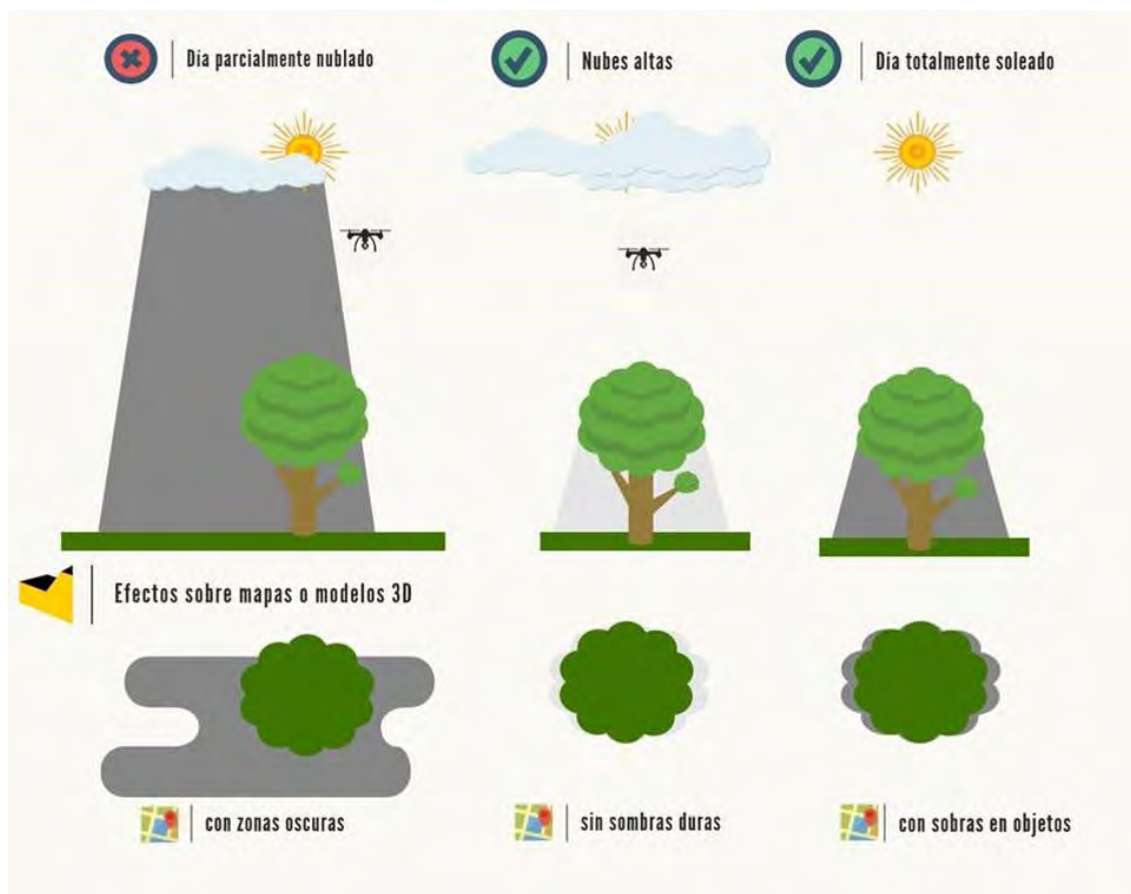
Figura 4. 22: Efecto de las sombras según los distintos tipos de luz en los modelos tridimensionales capturados con VANT. Fuente: terradron.cat.
