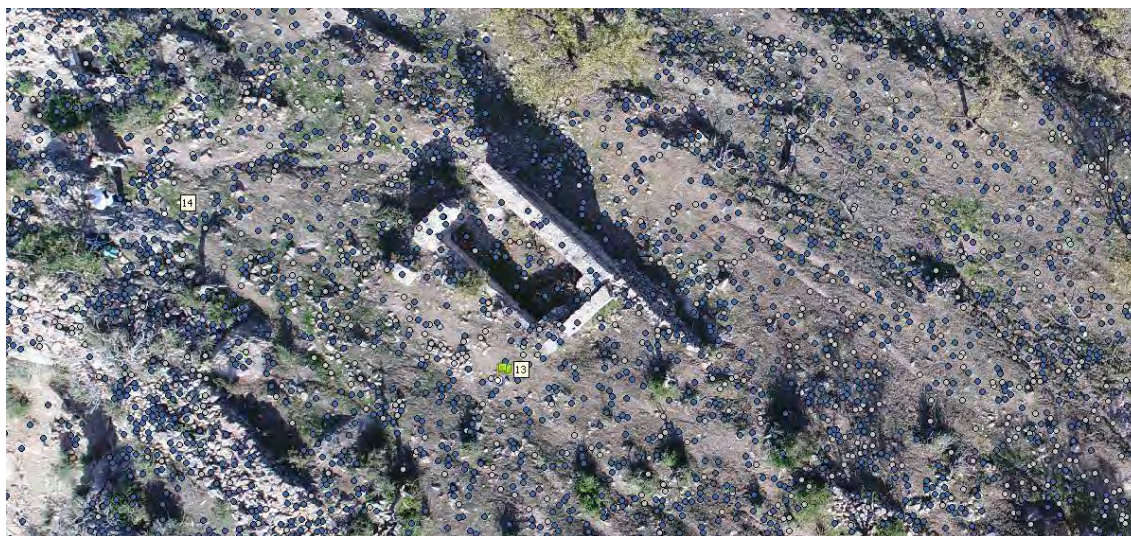
Figura 4. 28: Detección de puntos SIFT en las imágenes. La correlación de estos puntos permite la localización y orientación de pares de imágenes mediante algoritmo de ajuste Bundler (Rouco Collazo, Benavides López, et al. 2020).
