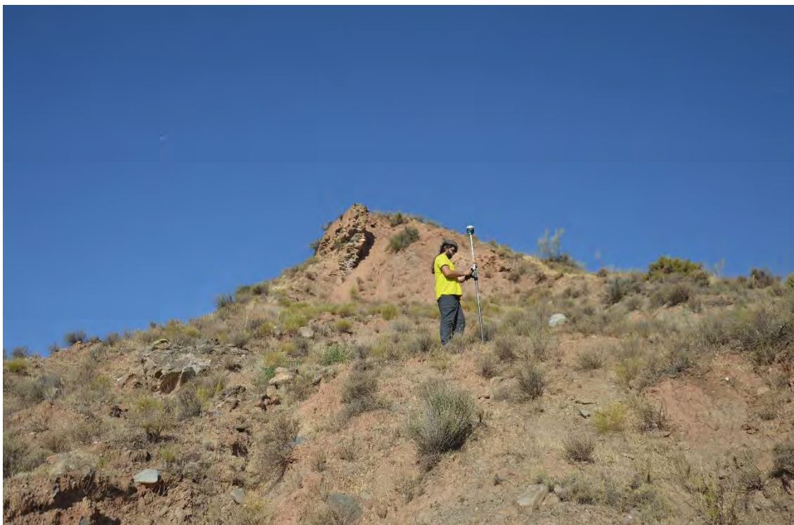
Figura 4. 9: Toma de puntos en el castillejo de Válor mediante GPS GNSS.
