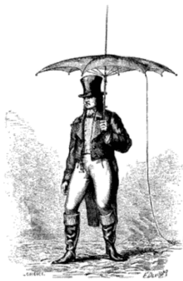
Fig. 16. Para-rayos diseñado por Barbeau Dubourg. Publicado por el Padre Paulian en 1790. Louis Figuier. Les merveilles de la science ,
