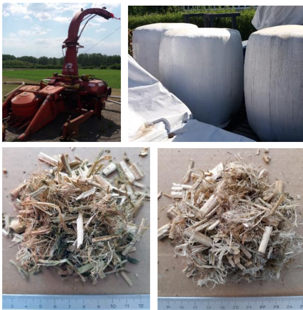
Figura 4: Imágenes de una picadora de recolección con empacadora (arriba izq.) y balas cilíndricas con películas de ensilaje (arriba der.), tomadas durante una visita en (ATB, 2020), Potsdam (Alemania). Detalle de agregados de cáñamo de tallo íntegro, picados, de cáñamo fresco recién cosechado (F-) (abajo izq.) y cáñamo obtenido de la preservación anaeróbica húmeda de 6 meses (C-) (abajo der.).
