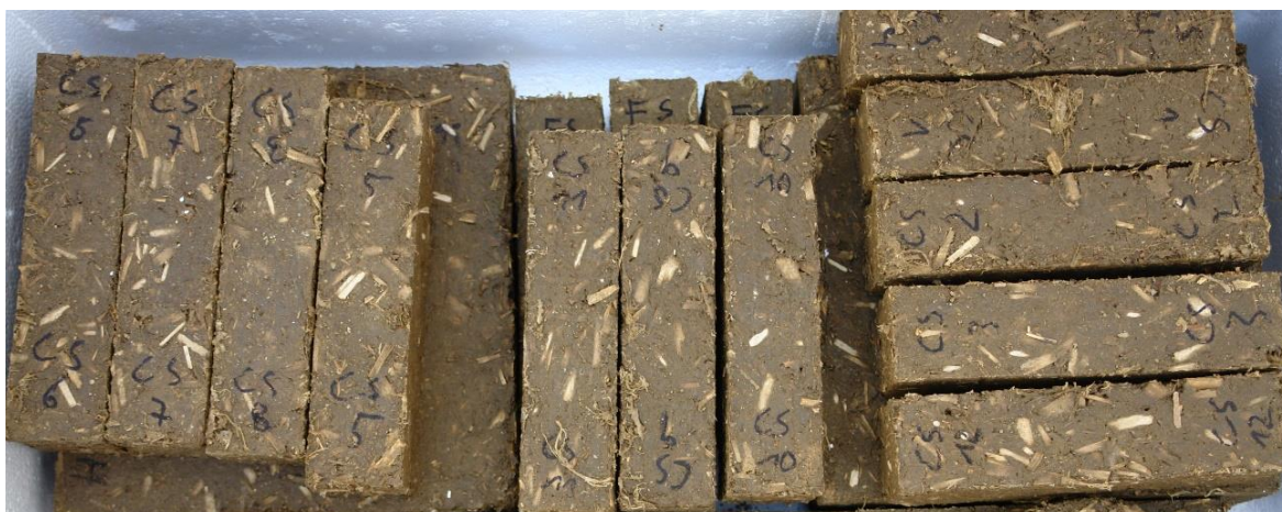
Figura 14: Probetas CSH tras el secado en el horno.
