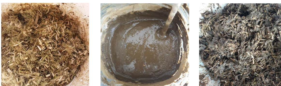
Figura 10: (de izq. a der.) agregado de cáñamo (no preservado), lechada de aglutinantes (geopolímero de arcilla) y hormigón FSH tras el mezclado.
