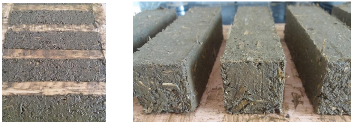
Figura 11: Probetas FSH durante el curado en el molde (imagen izq.) y recién desencofradas (imagen der.).
