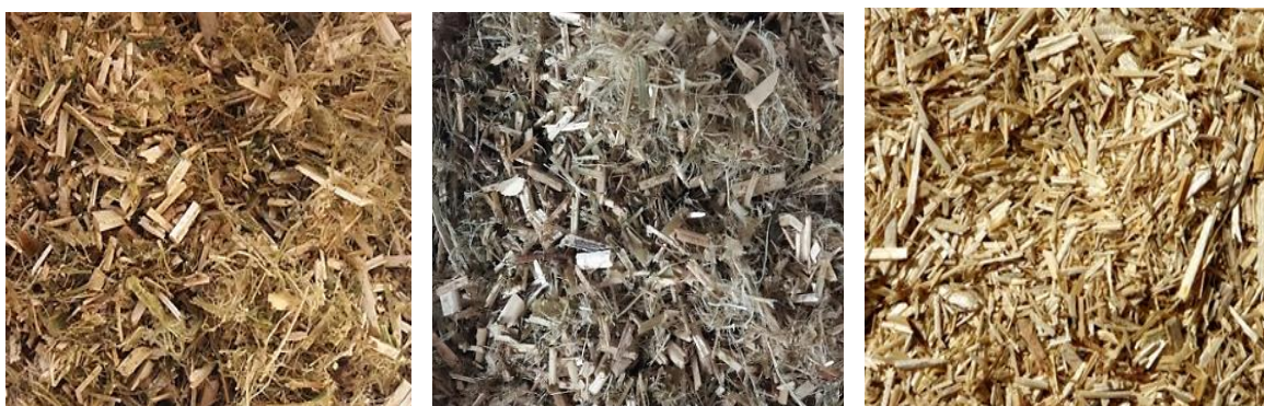
Figura 7: Agregados de cáñamo picado fresco, recién cosechado (imagen izquierda), cáñamo picado obtenido de la preservación anaeróbica húmeda de 6 meses (imagen central) y cañamiza comercial seca (imagen derecha).
