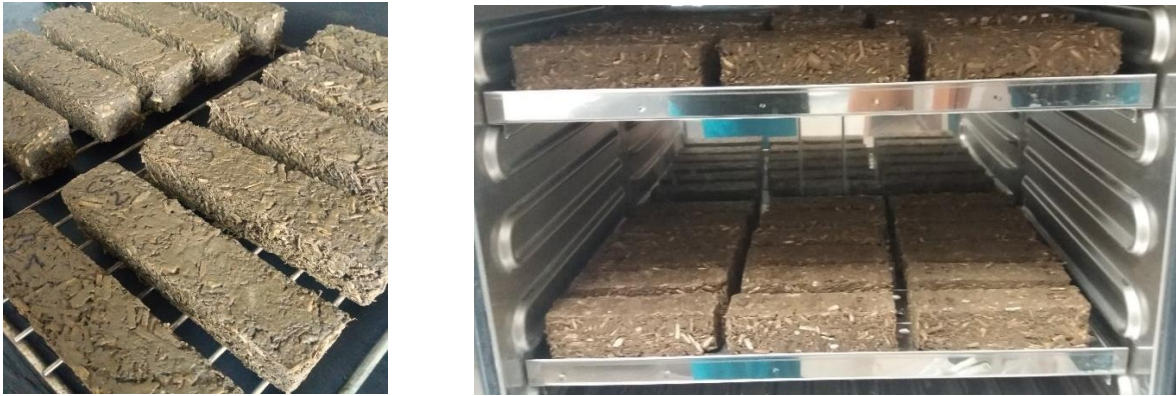
Figura 12: Probetas FSL recién desencofrados durante el secado en una rejilla y tras el secado en el horno.
