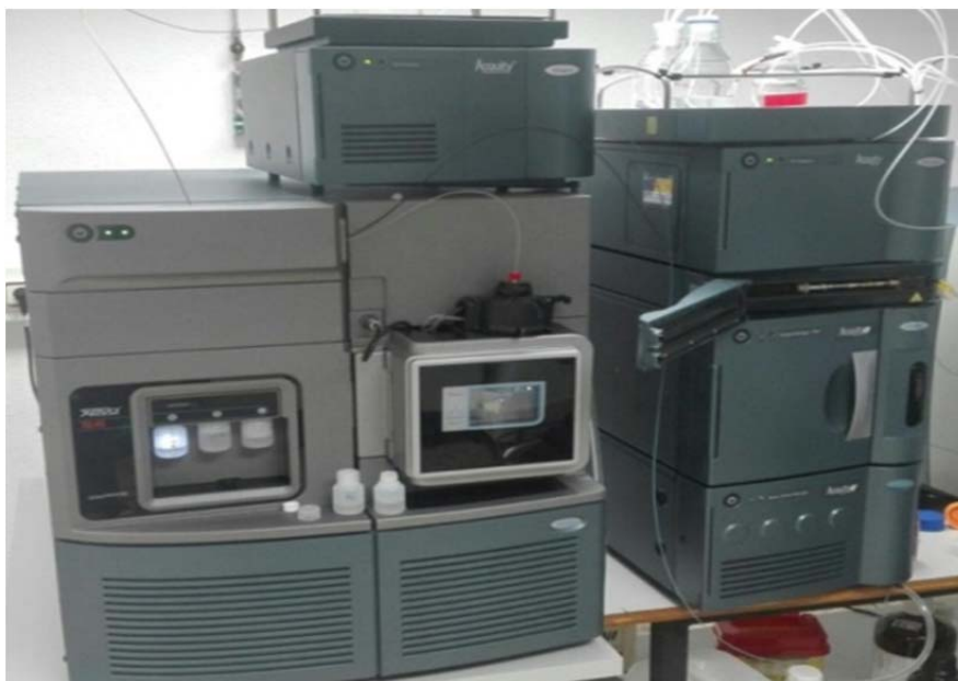
Figura I.1. Equipo de cromatografía de líquidos de ultra alta resolución acoplado a espectrometría de masas empleado. Waters Acquity UPLC™ I-Class–Xevo TQ-XS™.
