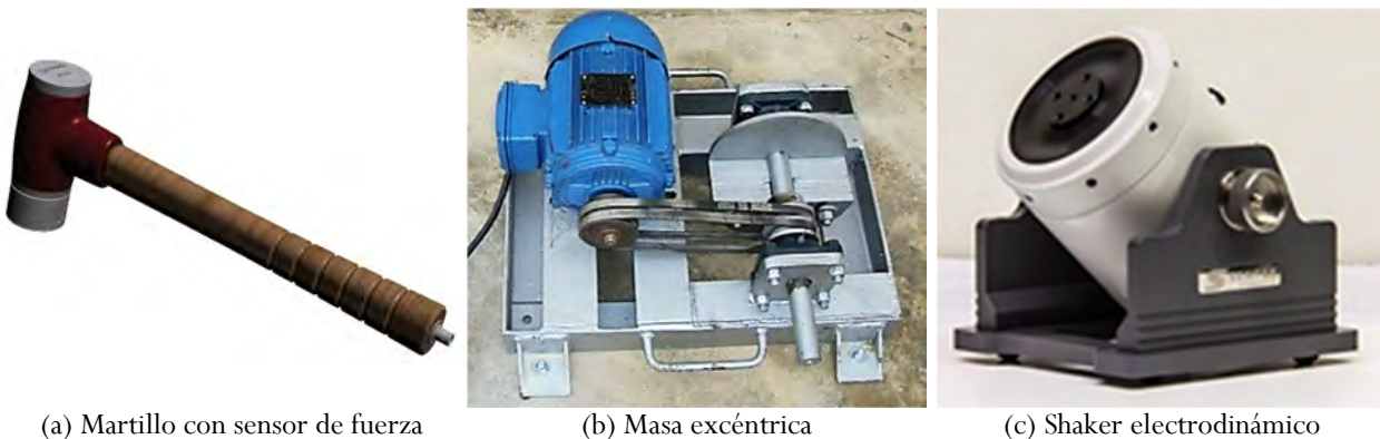
Figura 2-8 Equipos comúnmente usados para generar excitaciones controladas
