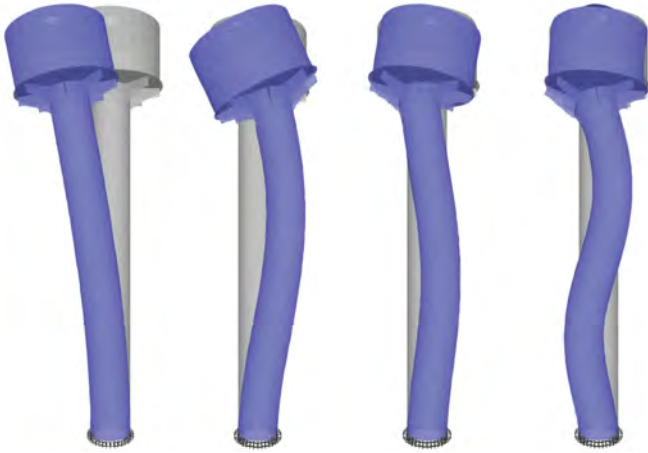
Figura 1-10 Algunas de las formas principales de movimiento vibratorio libre de una estructura de tanque elevado
