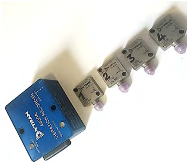
Figura 2-7 Sensores de aceleración: inalámbrico y cableados 6D y 3D (Grupo de investigación GICA - UPTC)
