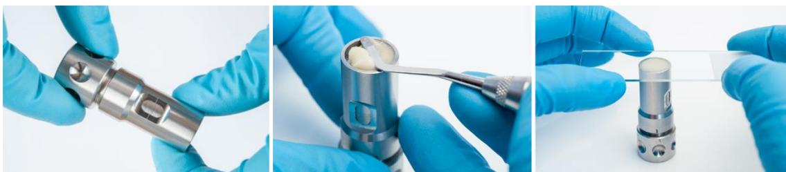
Figura 4.4. Proceso de fabricación de las muestras de los materiales one-shade para la evaluación de sus propiedades ópticas.
