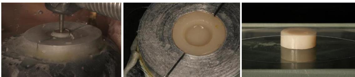
Figura 4.2. Proceso de fabricación de las muestras dual (D) del material one-shade para la evaluación de sus propiedades colorimétricas.
