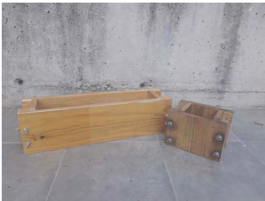
Figura 4.10: Moldes desmontables de madera para fabricación de las probetas de tapial
