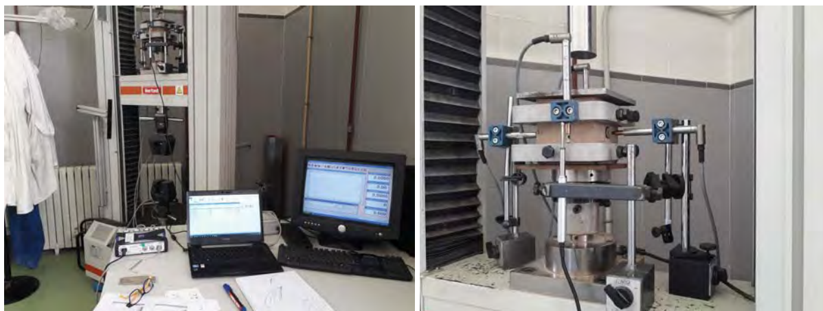
(a) Prensa y equipos de captación de datos
