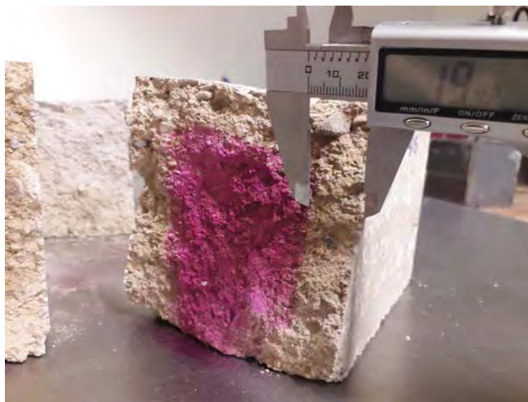
Figura 9.3: Carbonatación de la probeta prismática de sacrificio. Dosificación 3:1
