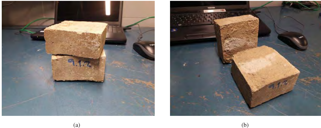
Figura 8.31: Sub-probeta cúbica ssP-9.1.2 tras su rotura no controlada
