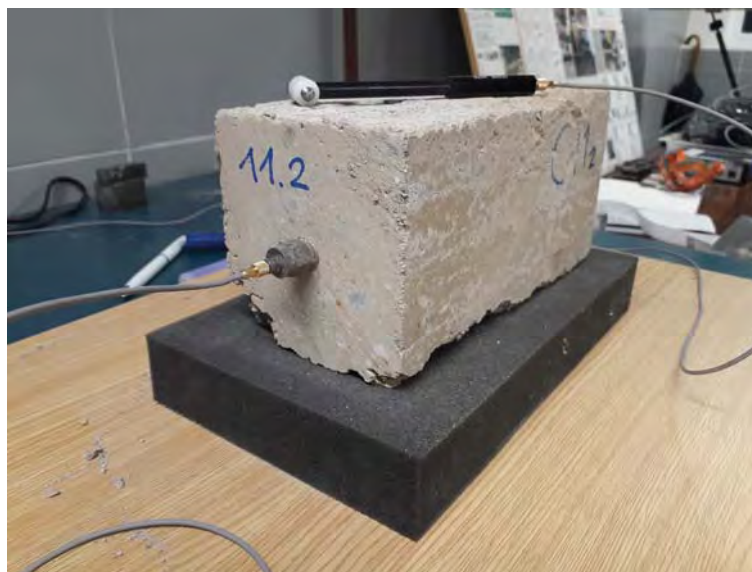
Figura 8.30: Vista de la preparación de la sub-probeta 11.2 en modo longitudinal
