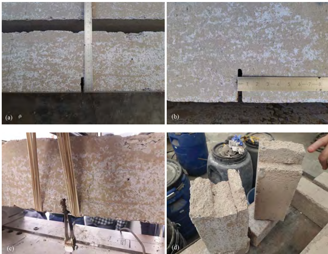
Figura 6.6: Dimensiones de entalla en probeta P-2 y su posterior rotura durante el ensayo
