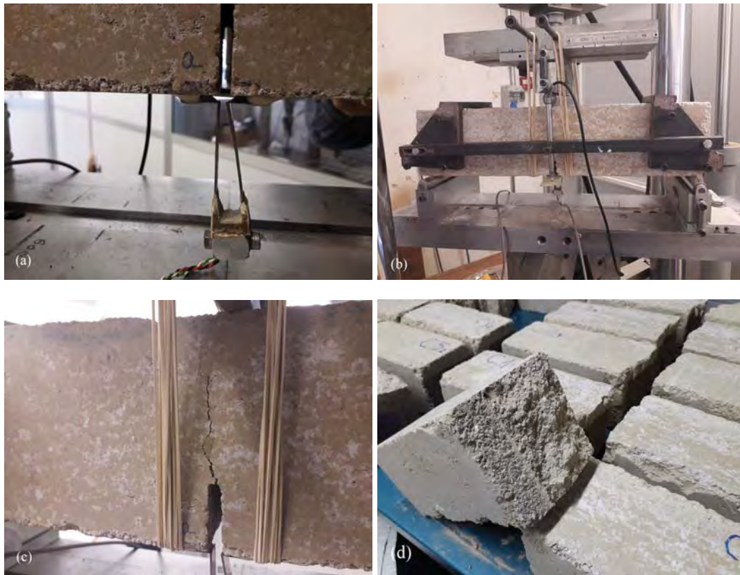
Figura 6.8: Imágenes de ensayo 3PBT sobre probeta P-1
