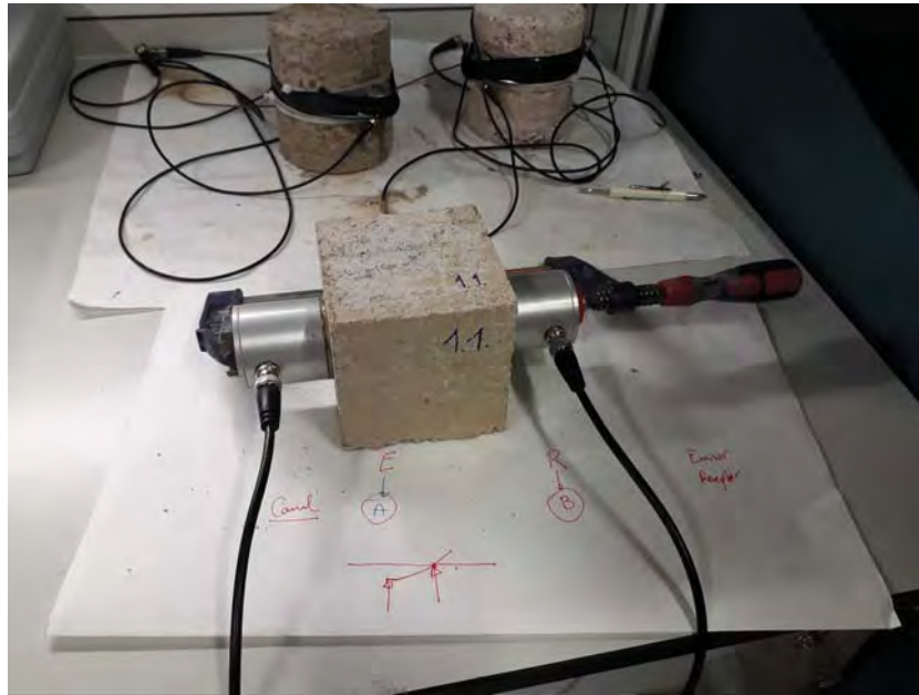
Figura 7.2: Probeta cúbica durante la realización de los ensayos UPV
