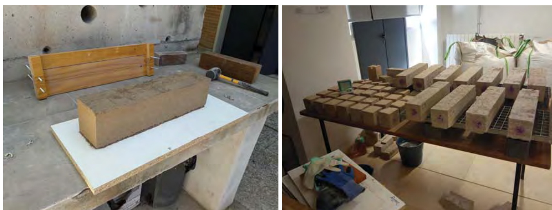
(a) Ejecución de probeta prismática
