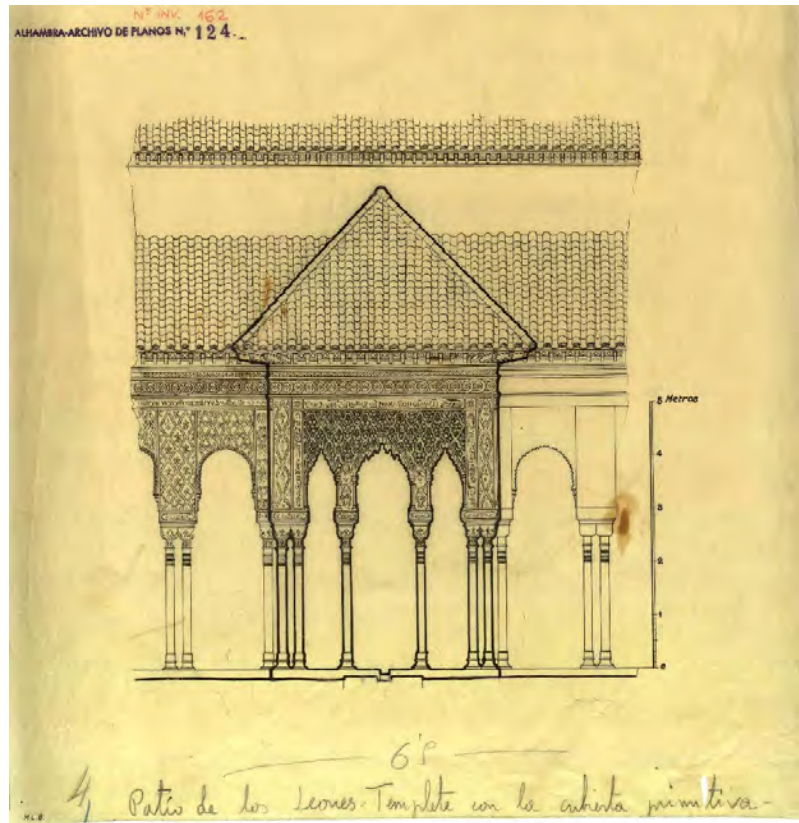
Fig. 268 Temple con la cubierta primitiva. Torres Balbás.( Patronato de la Alhambra y el Generalife).
