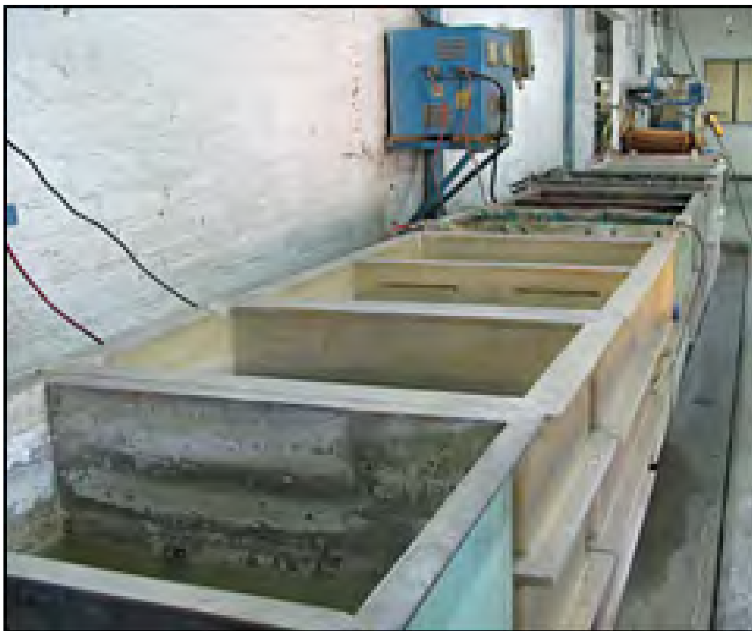
Fig. 348 Cubas galvanoplásticas. (Fotografía Francisco Serrano)
