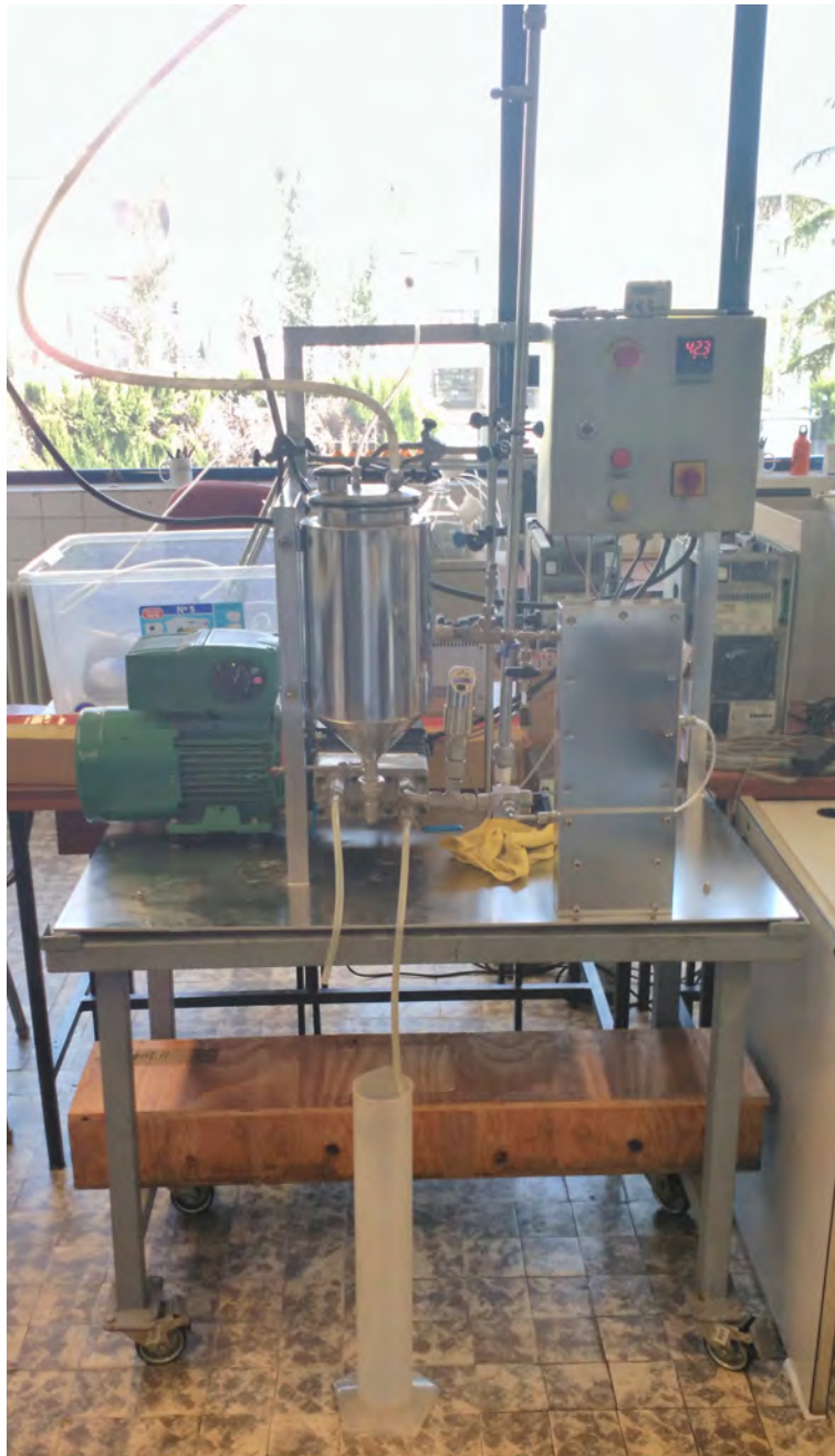
Figura 44. Equipo de membranas a escala de laboratorio para la limpieza de la membrana.
