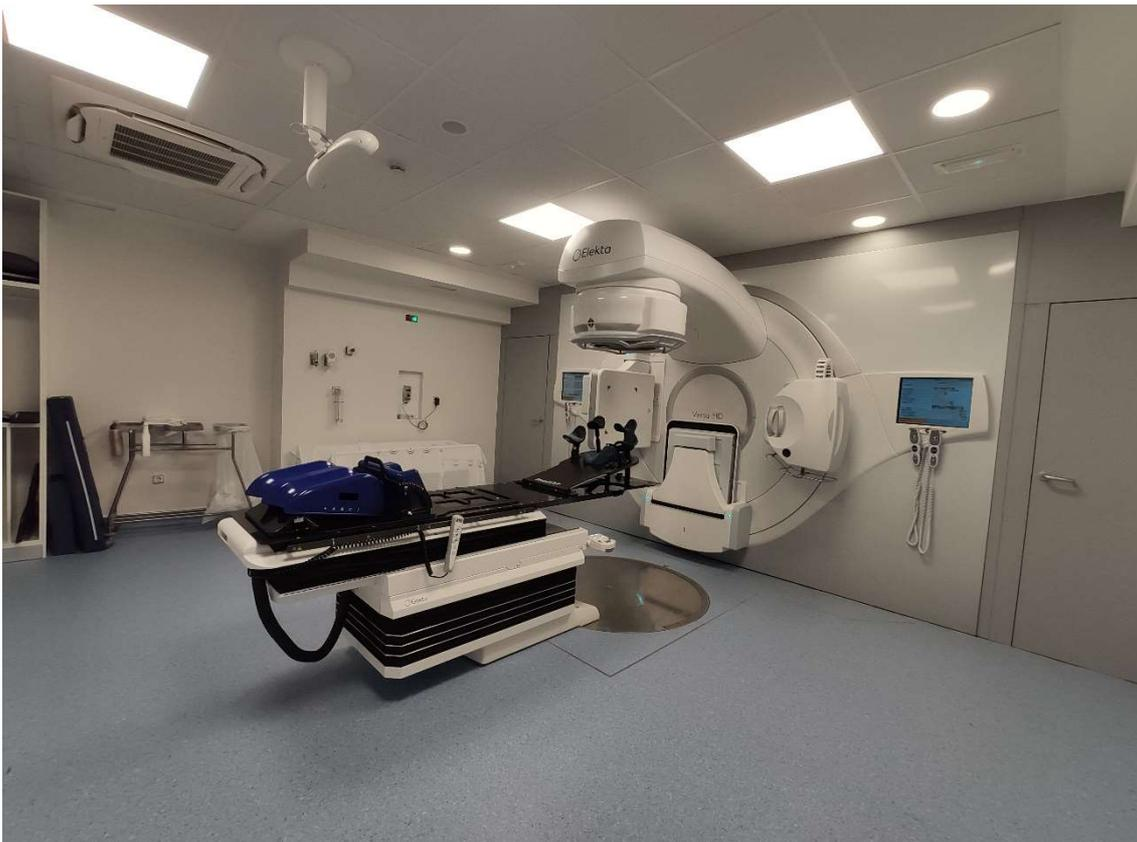
**Figura 2.** Acelerador de electrones utilizado en el Servicio de Oncología Radioterápica del Hospital Virgen de las Nieves. (Máquina generadora de rayos X de alta energía mediante la aceleración de electrones)
