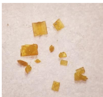
FIGURA 3.3. Cristales amarillos del compuesto 5 vistos con un estereomicroscopio Motic SMZ-168.
