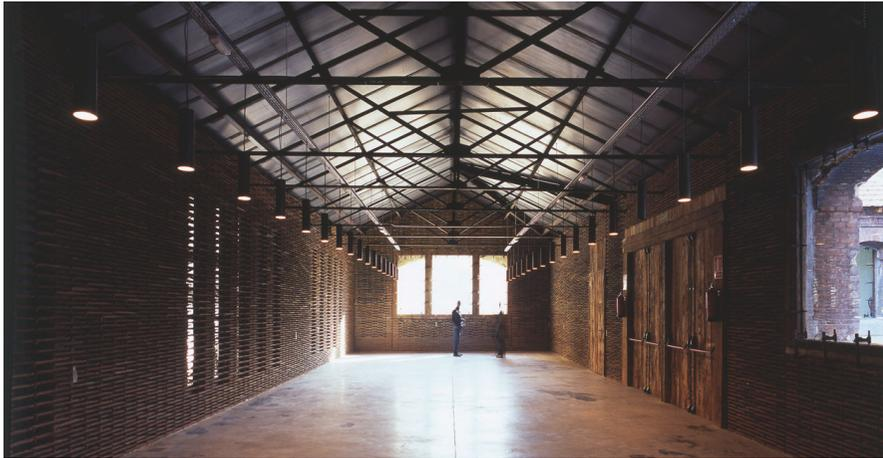
**Figura 47.** Nave 8 B Matadero de Madrid. 2009. Arturo Franco. La Construcción de la cubierta de teja a partir de vigas trianguladas preexistentes. Foto fuente: [https://images.adsttc.com/media/images/512a/a869/b3fc/4b11/a700/9cc4/large\\_jpg/1306167200-10.jpg?1414001549](https://images.adsttc.com/media/images/512a/a869/b3fc/4b11/a700/9cc4/large_jpg/1306167200-10.jpg?1414001549)
