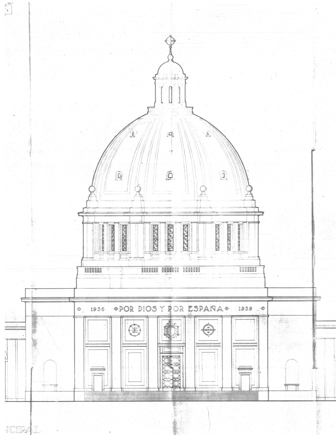
Fig 45. Plano del alzado propuesto para la fachada principal del Monumento a los Caídos de Pamplona (provisional). Víctor Eusa y José Yárnoz. 1941.
