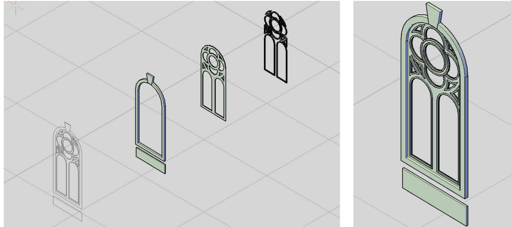
Fig 80. Captura del proceso del modelado de la geometría del ventanal trasero del monumento . Elaboración propia.
