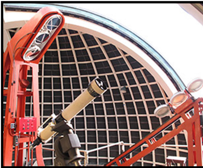
Heliostato triple y sección del funcionamiento de haces de la cúpula Oeste.
