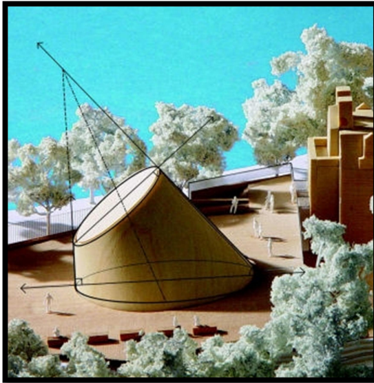
Razones geométricas y astronómicas del cono truncado del planetario.
