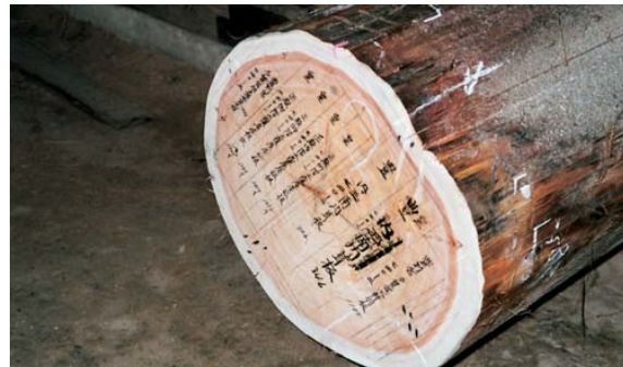
Fig 69. Tronco de madera con marcas en la sección que indican el aprovechamiento del mismo y el destino de las piezas.
