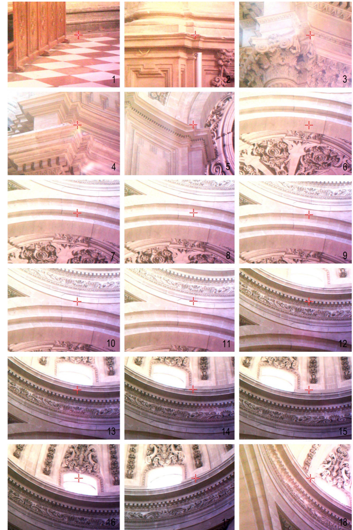
Figura 151: Puntos medidos con la estación. Fuente: Elaboración propia.
