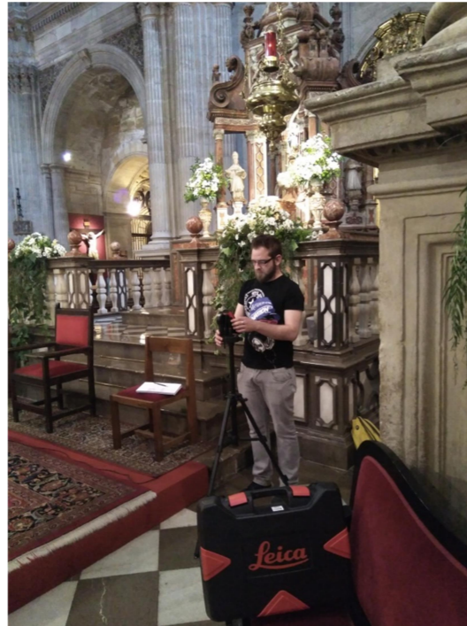
Figura 150: Medición con estación y distanciómetro láser. Fuente: Elaboración propia.
