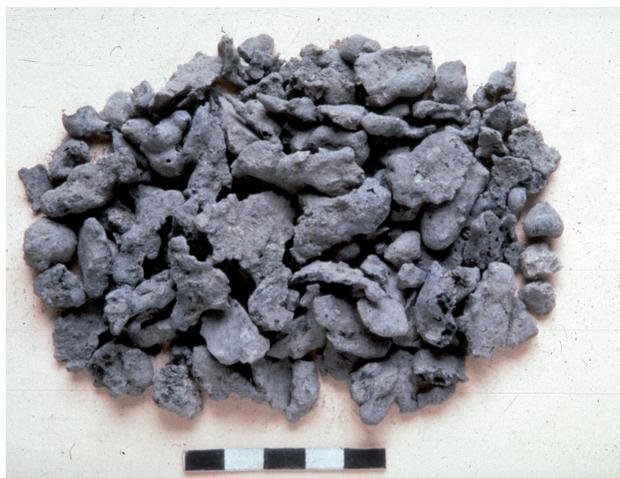
Fig. 78.—Fragmentos de cobre tras la reducción (fotografía GEPRAN).
