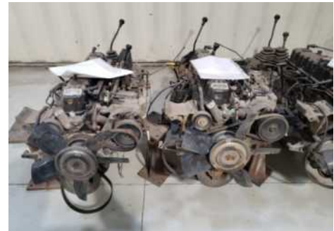
Imagen 125: Imágenes del motor de combustión interna (AMC - 4 litros, 6 cilindros en línea); fuente, Manual de servicio AIL Storm.
