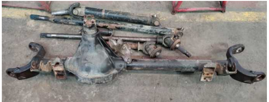
Imagen 109: Diferencial delantero y conjunto de cardanes; fuente, Ramírez G., (2019).
