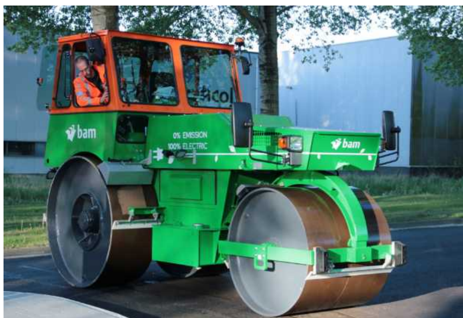
Imagen 28: Rodillo eléctrico compactador de asfalto modificado; fuente, BAM Infra Nederland.
