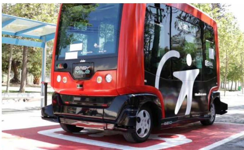
Imagen 52: Minibús eléctrico autónomo, en fase de implementación y pruebas en un parque de la ciudad de Santiago de Chile (2020); fuente, www.publimetro.cl
