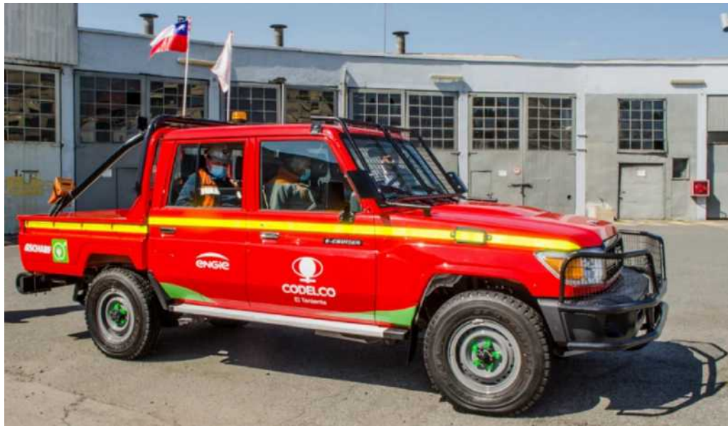
Imagen 57: Camioneta Toyota Land Cruiser eléctrica, originalmente con motor de combustión interna, modificada en Alemania y actualmente en uso por parte de la cuprífera CODELCO, para el transporte de personas; fuente: www.lun.com
