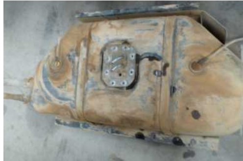
Imagen 124: Depósito de combustible removido de un SCI; fuente, Ramírez G. (2019).
