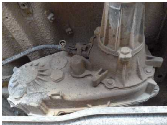
Imagen 110: Caja de transferencia del vehículo en estudio, vista trasera; fuente, Ramírez G., (2019).
