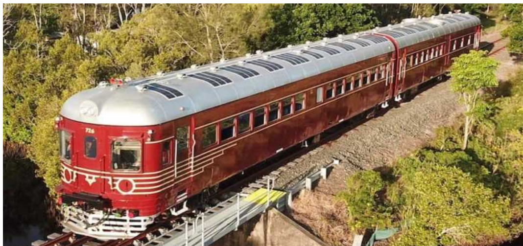
Imagen 85: Ferrocarril de Byron Bay, Australia, data de 1949, modificado en el año 2017, con la adición de un motor eléctrico que funciona con baterías y paneles solares, generando 6,6 kW; fuente, www.hipertextual.com
