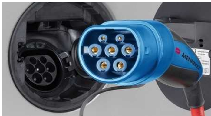
Imagen 65: Conector de tipo 2 (Mennekes); fuente, www.lugenergy.com
