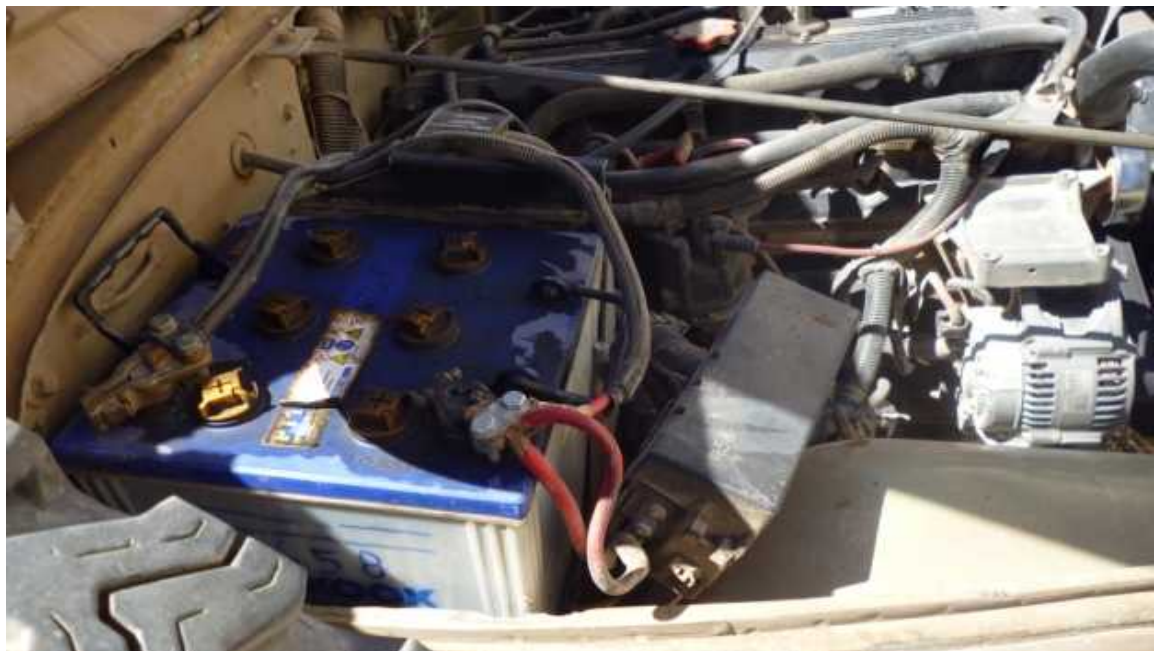
Imagen 71: Batería de ácido-plomo instalada en un vehículo militar; fuente, Ramírez G. (2019).
