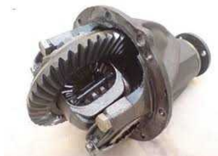
Imagen 107: Grupo cónico-diferencial del vehículo en estudio; fuente, Manual de servicio AIL Storm.
