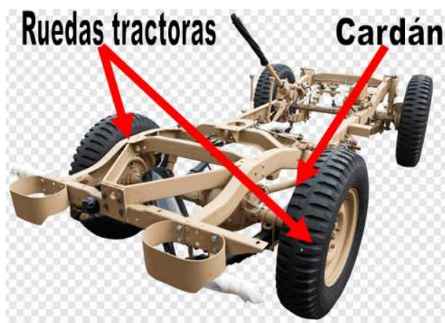
Imagen 106: Componentes que constituyen la cadena cinética del vehículo; fuente, www.pngwing.com
