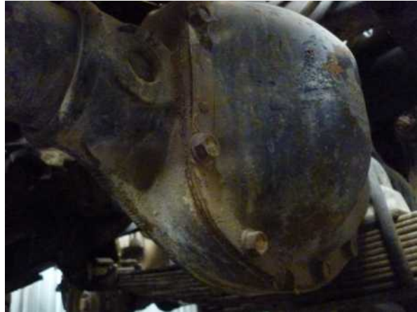
Imagen 108: Diferencial trasero del vehículo en estudio; fuente Ramírez G., (2019).
