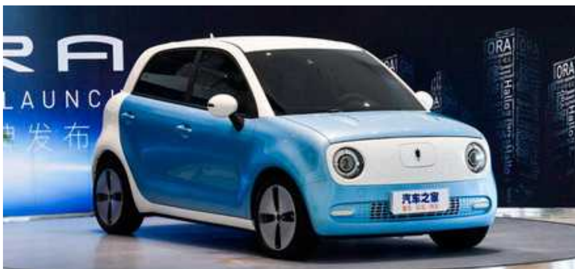
Imagen 27: ORAR 1, vehículo eléctrico de 47cv (35 kW) con una autonomía de entre 310 km y 351 km; fuente, Great Wall.
