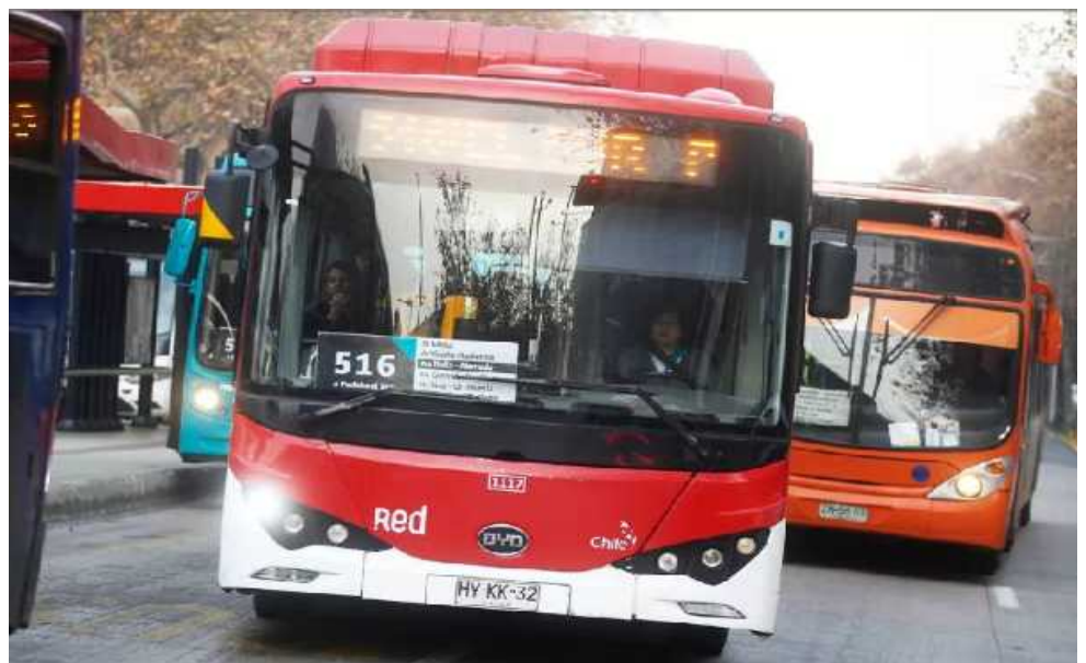
Imagen 51: Autobús de la marca BYD, modelo articulado, con capacidad de 104 pasajeros y autonomía de 250 km; fuente, RED.
