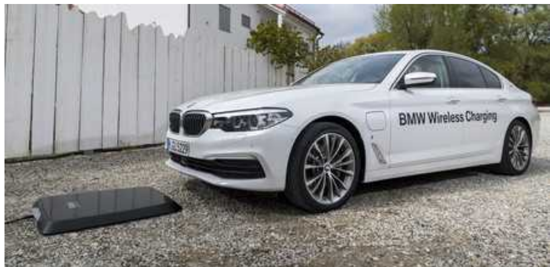
Imagen 69: Sistema de recarga experimental mediante inducción; fuente, BMW Blog.
