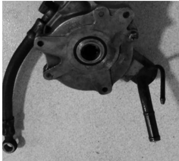
Imagen 138: Depresor o bomba de vacío, incorporado a un alternador; fuente, Roberts C., (2020).
