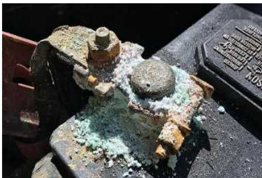
Imagen 70: Terminal positivo “Sulfatado” de una batería de ácido-plomo; fuente, Roberts C., (2018).
