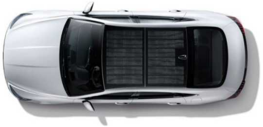
Imagen 84: Hyundai Sonata Hybrid, con una estructura de paneles solares en el techo; fuente, www.actualidadmotor.com
