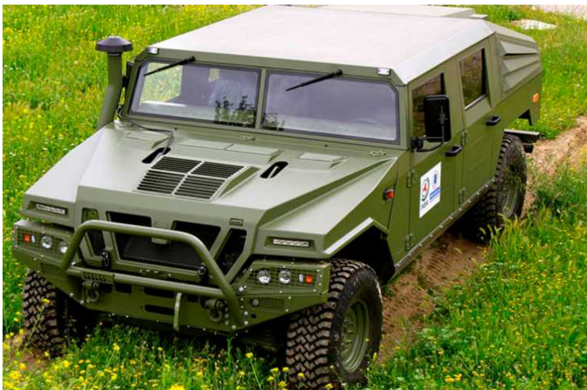
Imagen 25: Vehículo híbrido-eléctrico “URO Vamtac”, con estándares militares todo terreno y con “Autonomía extendida”; fuente, www.hibridosyelectricos.com
