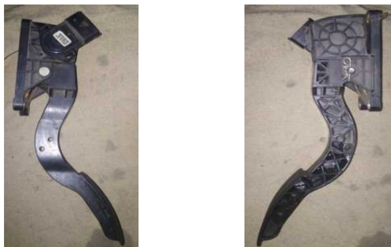
Imagen 135: Acelerador electrónico, con potenciómetro incorporado, vistas laterales; fuente, Descovic S., (2019).
