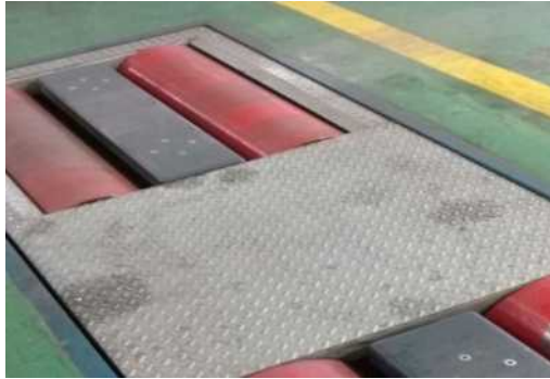
Imagen 116: Dinamómetro (rodillos); fuente, Roberts C., (2019).
