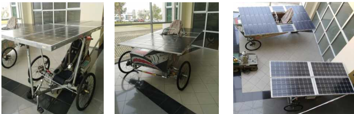
Imagen 64: VEs experimentales con recarga mediante paneles solares fotovoltaicos, fabricados por alumnos de la Academia Politécnica Militar del Ejército 128 (ACAPOMIL), los cuales participaron en carreras de vehículos solares; fuente, Roberts C., (2019).
