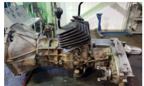
Imagen 126: Sistema de transmisión (caja de cambios manual); fuente, Manual de servicio AIL Storm.
