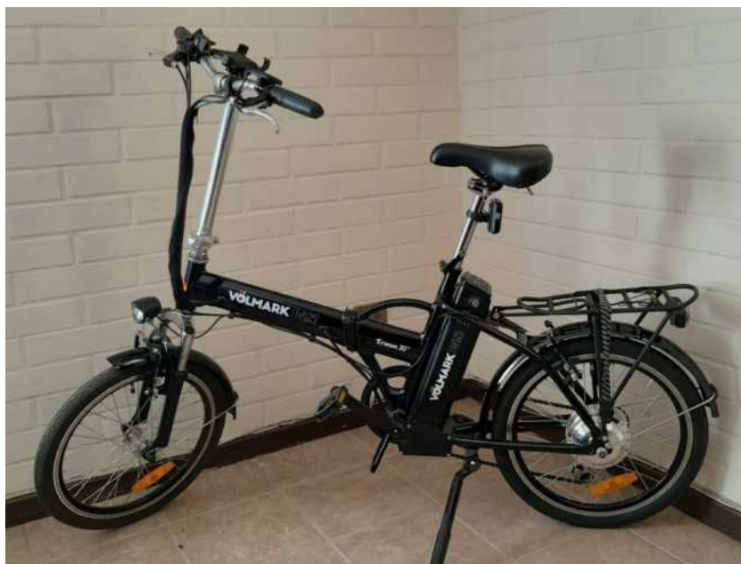
Imagen 60: Bicicleta eléctrica Völmärk, con autonomía de 25 km con sus baterías de iones de Litio, o de 60 km en ciclo combinado, a través del uso de los pedales, fuente, Gómez J., (2020).
