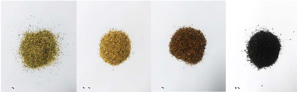
Figura 1-1: Aspecto del residuo biomásico a) GCR b) GCR200-15 c) GCR250-15 d) GCR300-15.
