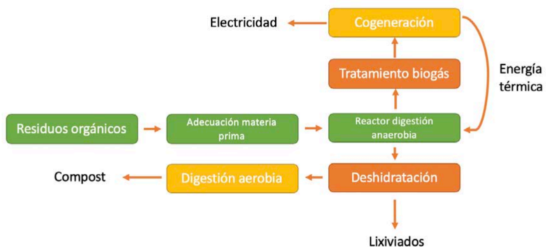
Figura 0-14: Esquema proceso digestión anaerobia. [Fuente: elaboración propia a partir de IDAE, 2011a].
