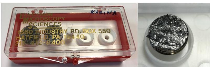
Figura II.31 Muestras de xerogeles cubiertas de carbón para SEM.
