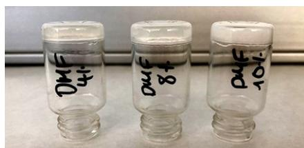
Figura II.9 Geles de **1** en DMF-H<sub>2</sub>O a concentraciones crecientes de gelador. De izquierda a derecha: vial 1 a 4% (p/v) (40 mg/1 mL), vial 2 a 8% (p/v) (80 mg/1 mL), vial 3 a 10% (p/v) (100 mg/1 mL).
