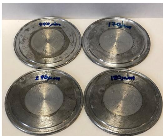
Figura II.34 Geles de 1 con DMSO en placas paralelas para mediciones reológicas.
