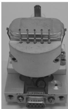
Figura 5.6 Celda de medida donde se encuentran los electrodos.
