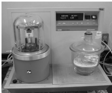
Figura 5.4 Vista del analizador dieléctrico DEA 2970.
