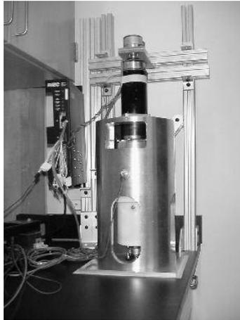
Figura 2.6 Fotografía de un freno industrial basado en tecnología ER.
