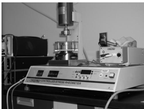
Figura 6.1 Fotografía del reómetro Carri-med de esfuerzo controlado empleado para la medida de viscosidades.
