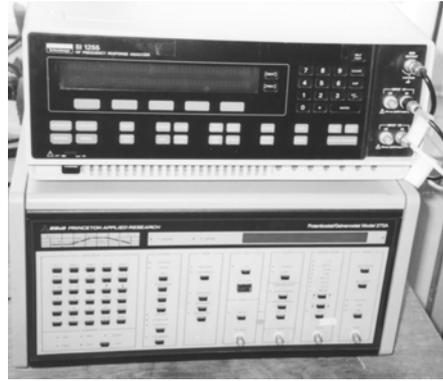
Figura 5.1 Fotografía del analizador de impedancias EG&G modelo 388: (abajo) potenciómetro EG&G 273 y (arriba) analizador de respuesta de alta frecuencia Schlumberger SI 1255 FRA.
