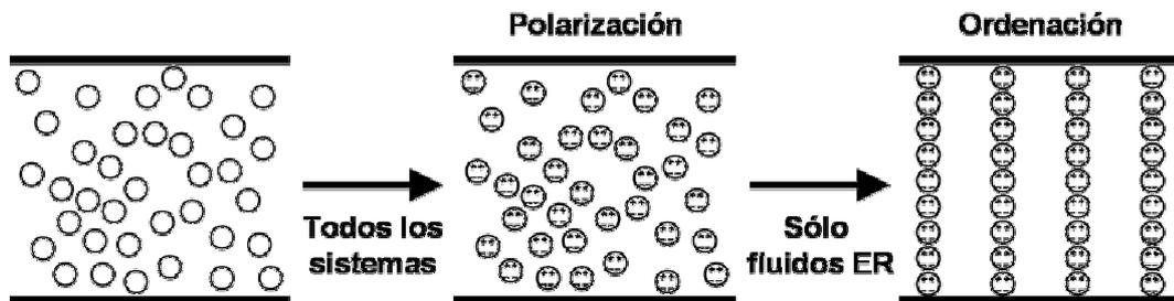
Figura 2.5 Esquema del comportamiento de partículas con y sin respuesta ER.
