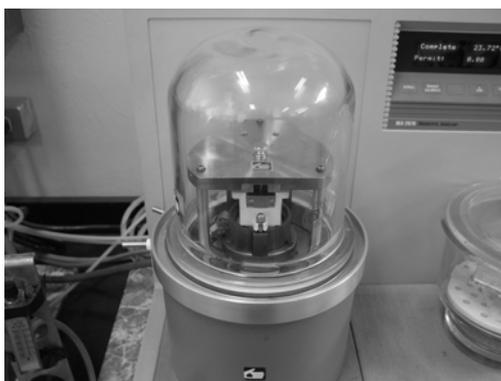
Figura 5.7 Posición de la célula durante el proceso de medida.
