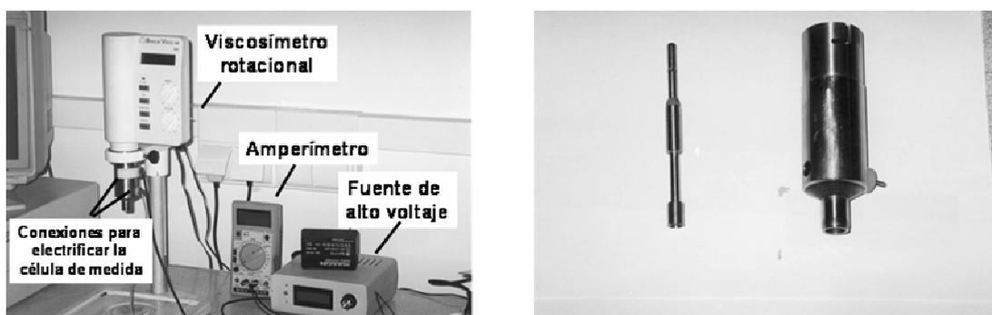
Figura 7.34 Fotografías del reómetro modificado para la aplicación del campo eléctrico (a) y geometría de medida empleada (b).
