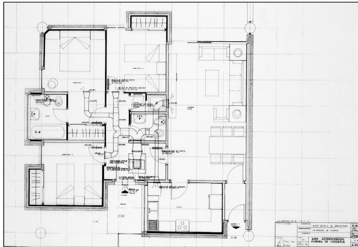
Figura 5: Plano de los conductos de aire acondicionado de la vivienda del bedel de la Escuela de Arquitectura de la Universidad de Navarra
