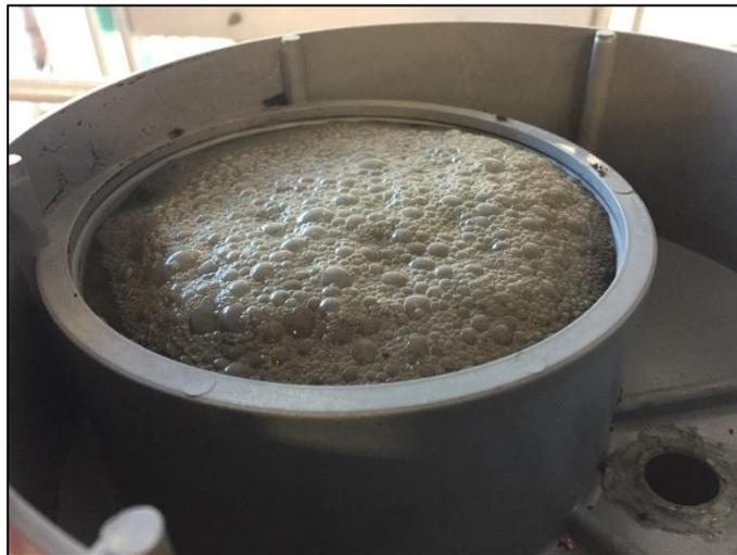
*Figura 3.2. Rebosadero de la parte superior de la columna de lixiviación en operación*
