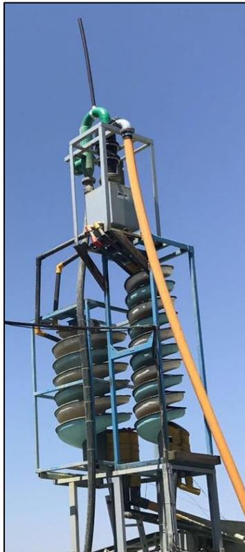
*Figura 1.17. Detalle del hidrociclón y líneas de espirales empleadas en la concentración gravimétrica del azufre*
