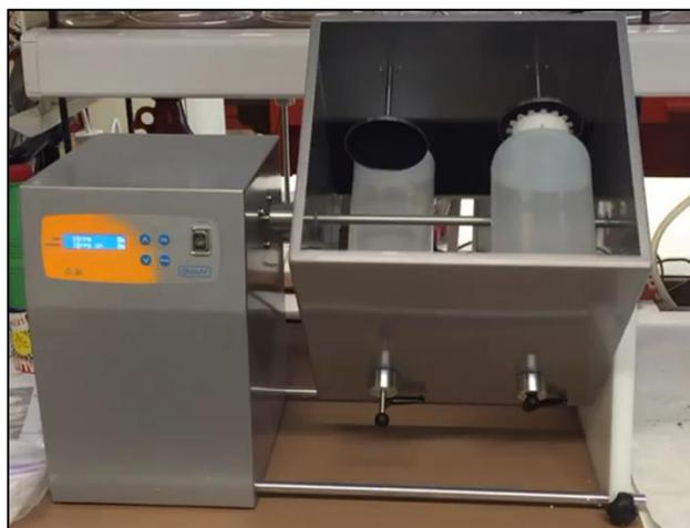
Figura 2.3. Equipo de agitación rotatorio usado en los ensayos de lixiviación
