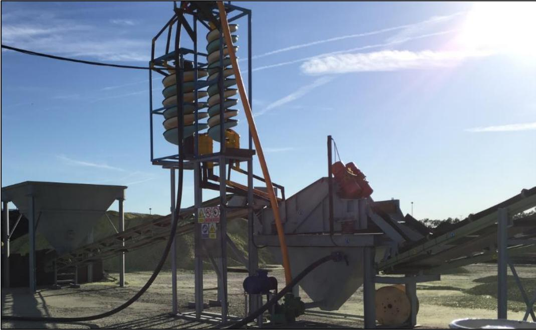
*Figura 1.16. Línea de espirales para concentración gravimétrica de azufre*
