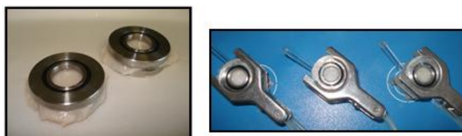
Figura 16. Discos de acero para células de Franz
