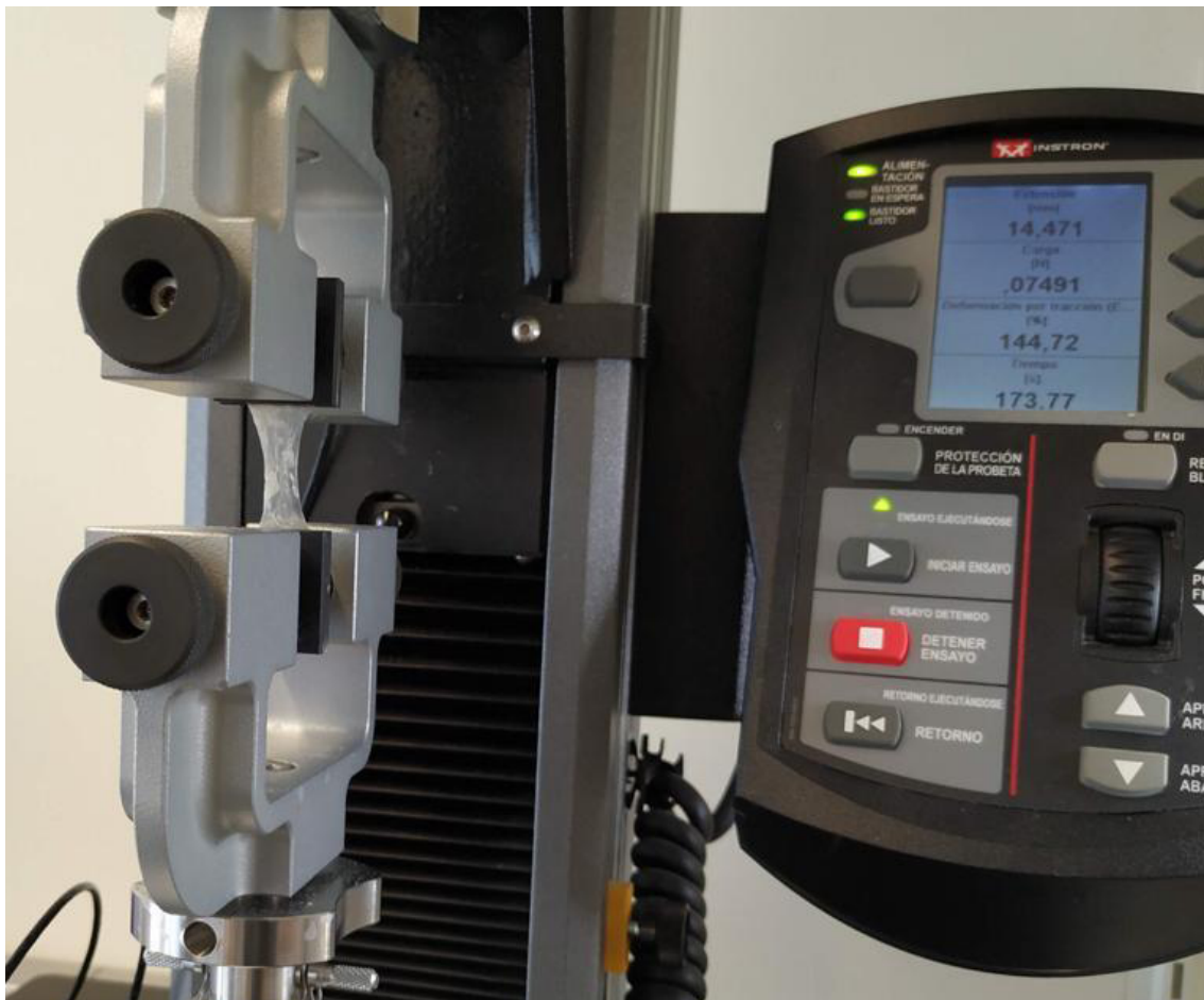
Figura 16: Ensayo de tracción realizado a un hidrogel nanoestructurado de fibrina-agarosa empleando la máquina de prueba universal Instron (Modelo 5943).
