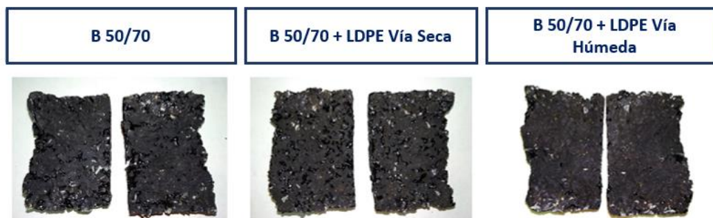
Figura 134. Aspecto de las distintas mezclas tras su rotura a tracción indirecta.
