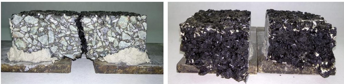
Figura 140. SMA 11 con LDPE de consumo doméstico tras rotura.
