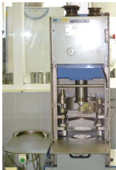
Figura 74. Compactador giratorio empleado en el análisis de trabajabilidad.
