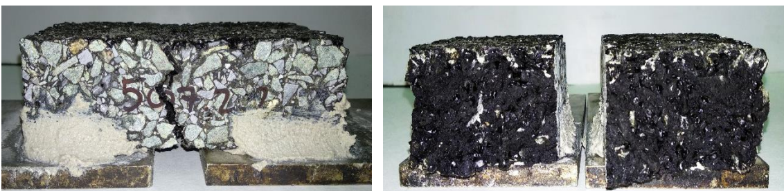
Figura 142. SMA 11 con LDPE y PNFVU tras rotura.
