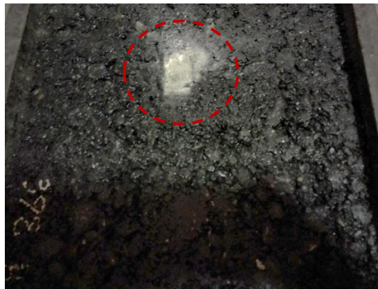
Figura 161. Aspecto de la muestra tras el ensayo de punzonamiento dinámico.
