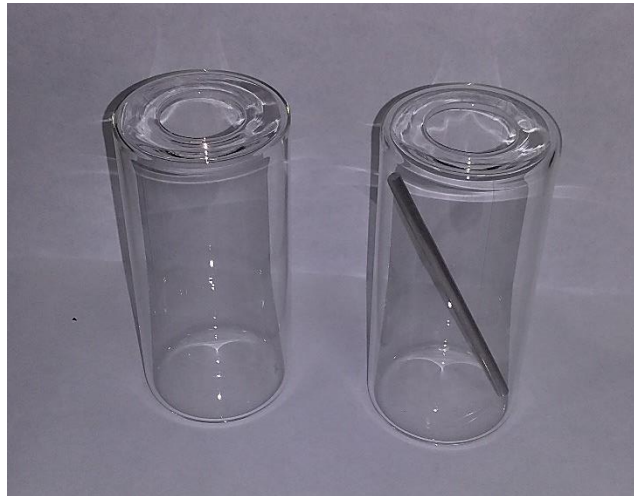
Figura A 9. Botellas empleadas para el ensayo RTFOT con y sin la incorporación de barra metálica.
