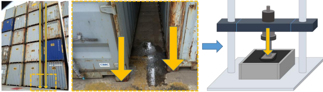
Figura 77. Ejemplo de la reproducción de las condiciones de carga que provocan el fenómeno de punzonamiento estático en pavimentos portuarios.
