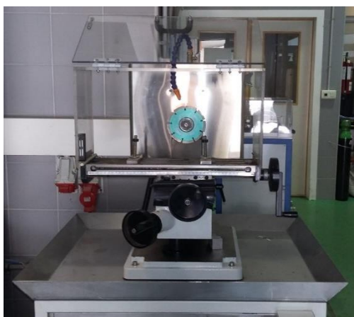
Figura 62. Cortadora de precisión por coordenadas empleada en la obtención de las muestras a analizar.
