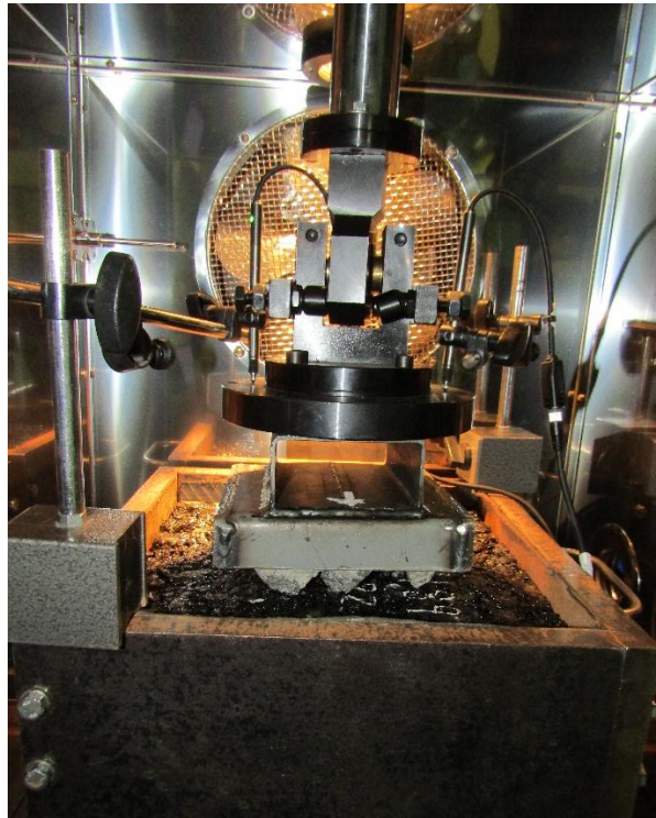
Figura A 22. Equipo empleado para el ensayo de punzonamiento.
