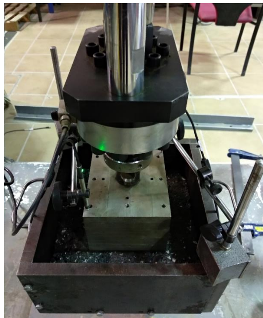
Figura A 24. Equipo y actuador empleados en el ensayo de punzonamiento estático.
