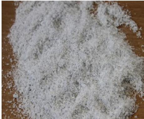
Figura 33. Partículas de PET empleadas en la modificación por vía seca (Modarres & Hamedi, 2014).
