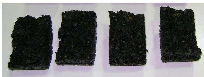
Figura 124. Aspecto de la rotura para el grupo húmedo de las mezclas combinación de LDPE + PNFVU.
