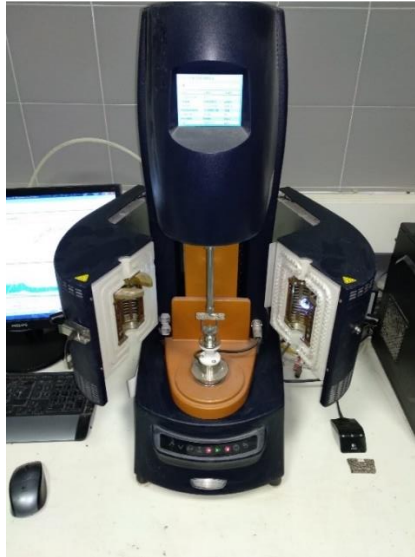
Figura 73. Equipo DMA empleado en la caracterización de los morteros bituminosos.
