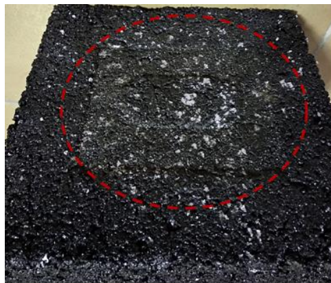
Figura 156. Aspecto de la mezcla tras su ensayo a punzonamiento estático.
