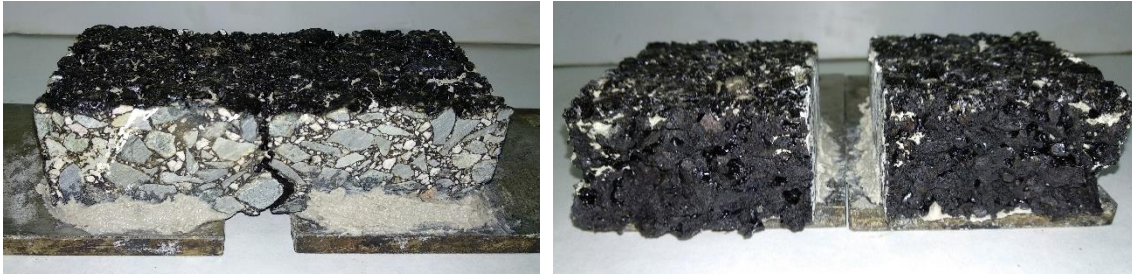
Figura 138. SMA 11 con B50/70 tras rotura.
