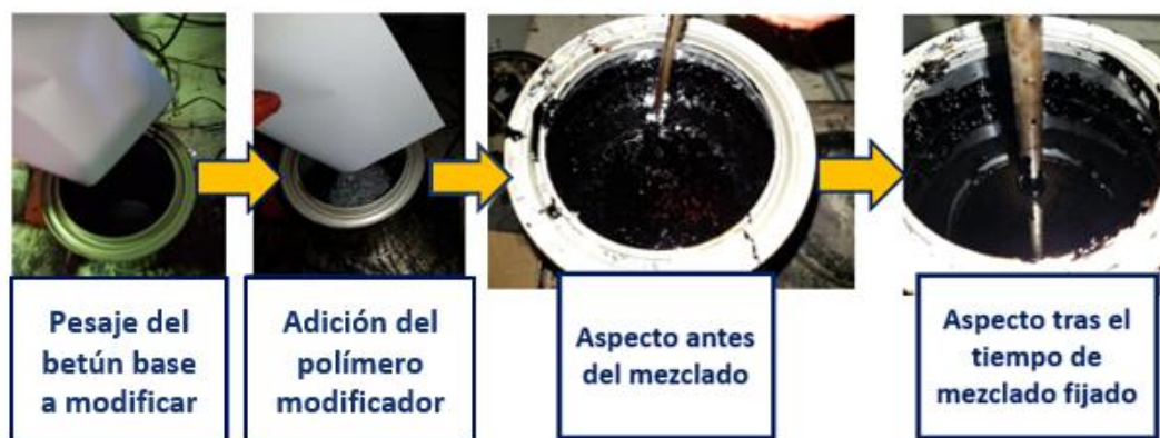
Figura 69. Esquema del proceso de mezclado empleado en la modificación de ligantes.
