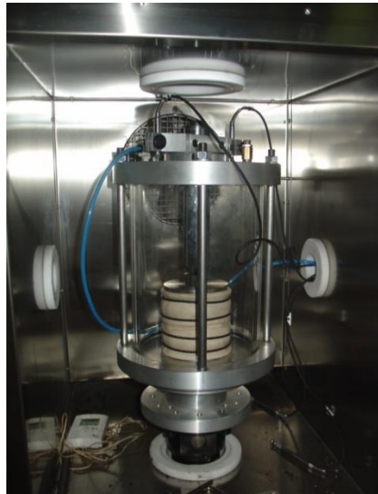
Figura A 21. Ensayo triaxial para la determinación de la resistencia a deformación permanente.
