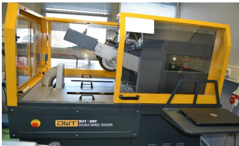
Figura A 18. Ensayo de rodadura.
