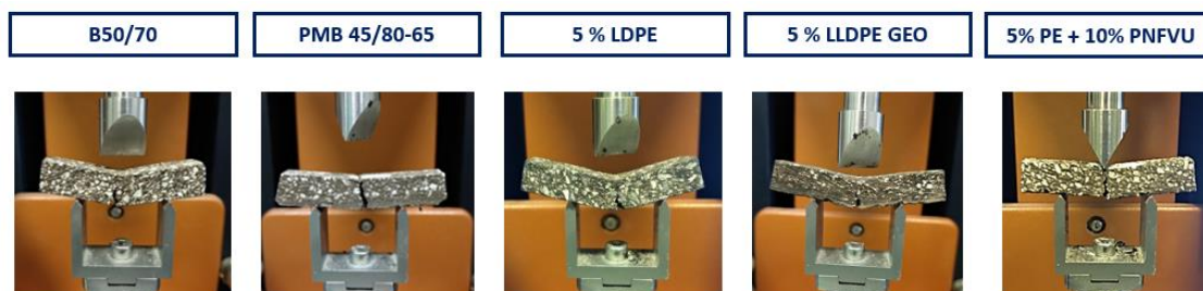
Figura 121. Aspecto de las muestras de mortero de los distintos ligantes tras su ensayo a fatiga.
