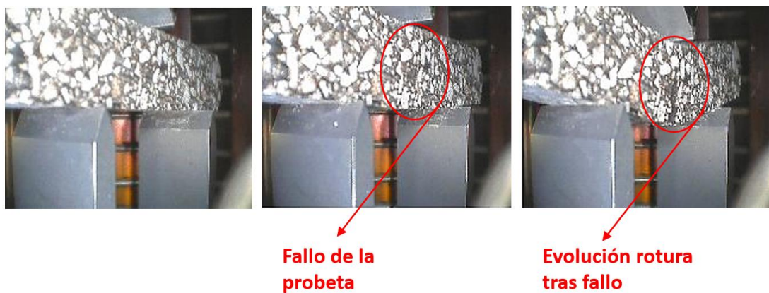
Figura A 12. Control de rotura de probetas por imagen.
