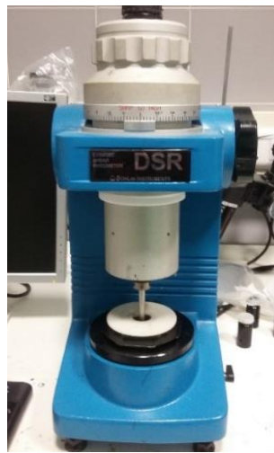
Figura 67. Reómetro dinámico de corte (DSR) para la caracterización reológica de los ligantes.
