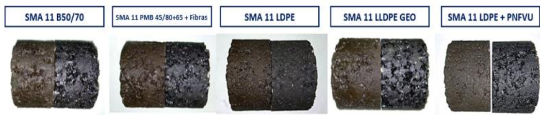
Figura 143. Aspecto de las distintas mezclas tras el ensayo SATS.
