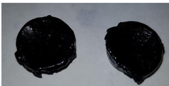
Figura 90. Aglomeraciones de LDPE encontradas en el ensayo de anillo y bola de la parte superior del mayor contenido de polímero estudiado.
