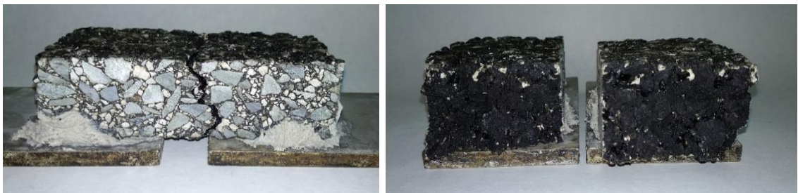
Figura 141. SMA 11 con LLDPE procedente de geomembrana tras rotura.
