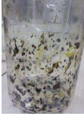
Figura A 17. Ensayo de escurrimiento de ligante por el método de Schellenberg (Jair, 2016).
