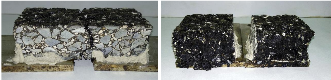
Figura 139. SMA 11 con PMB 45/80-65 y 0.3 % Fibras tras rotura.
