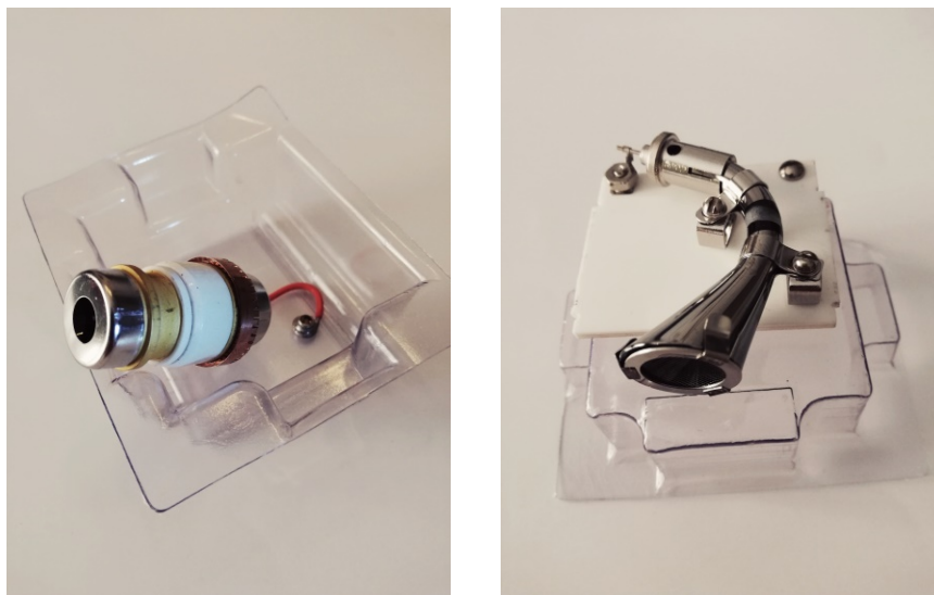
Figura 26 (izq). Electromultiplicador (G3170-80103) para detector de eje triple Agilent. Figura 27 (drcha.). Electromultiplicador de dínodo continuo Varian (modelo 4755GM) para espectrómetro Saturn 2000 (colección privada).
