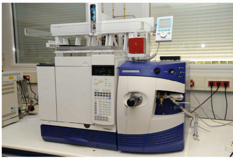
Figura 3.2. Cromatógrafo de gases Agilent y espectrómetro de masas con analizador de triple cuadrupolo (triple-quad) empleado para la caracterización e identificación de los esteroides en el extracto de P. decumanum .
