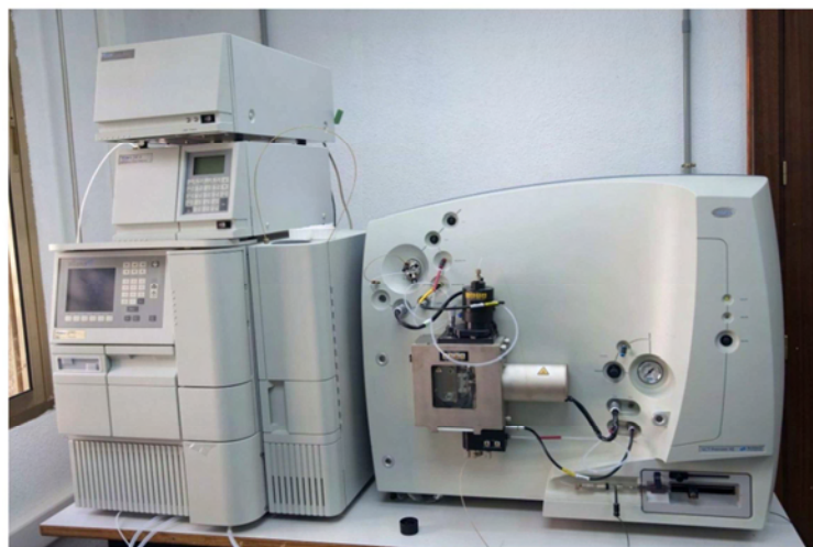
Figura 2.1. Cromatógrafo de líquidos Alliance 2795 acoplado a un espectrómetro de masas con analizador QTOF utilizado para la identificación de los componentes de P. decumanum .
