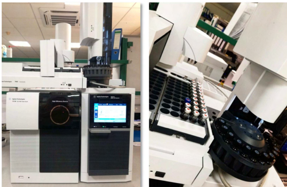
Figura 3.3. Cromatógrafo de gases Agilent Intuvo 9000 GC provisto de un espectrómetro de masas triple cuadrupolo utilizado para la cuantificación de los esteroides estudiados. Se muestra un detalle del inyector.
