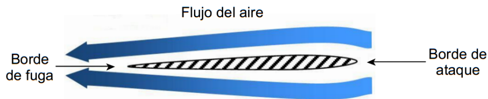
Figura 2.11: Descripción del perfil aerodinámico de una aleta
