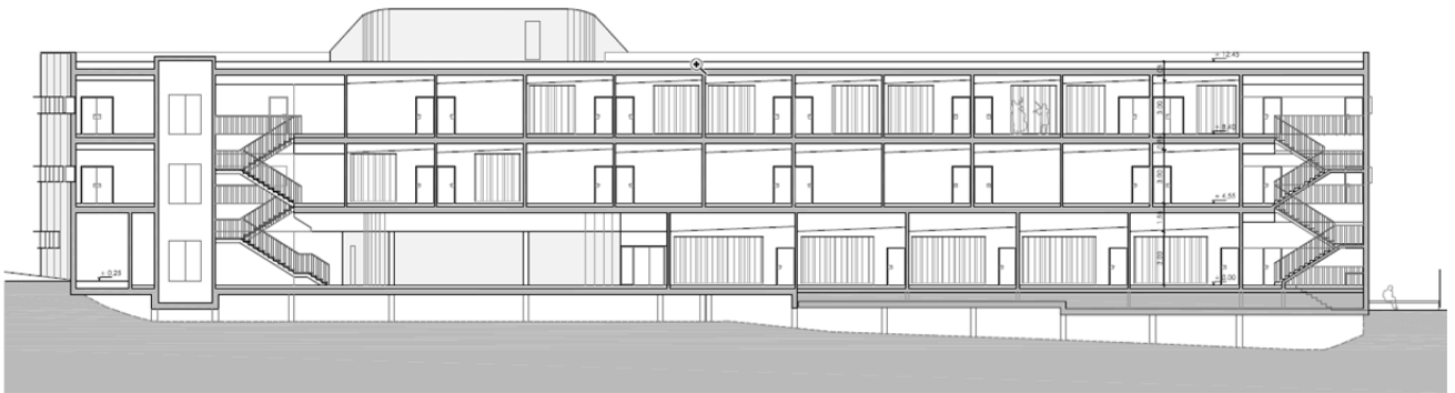
BB- SECCIÓN TRANSVERSAL POR ESCALERAS PRINCIPALES
