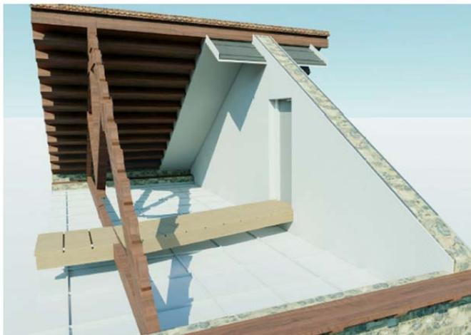
Vista detalle de sistema retardante instalado en muro existente.
