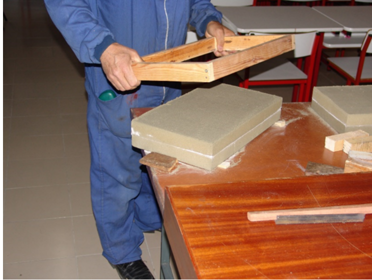
Fig.3.21. La retirada del marco de madera tras el endurecimiento de la arena
