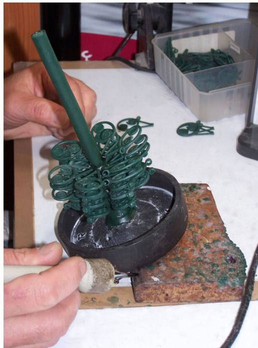
Fig.3.8. Árbol de fundición o árbol de colada realizado en cera, para el proceso de la fundición por microfundición. Imagen tomada de:
