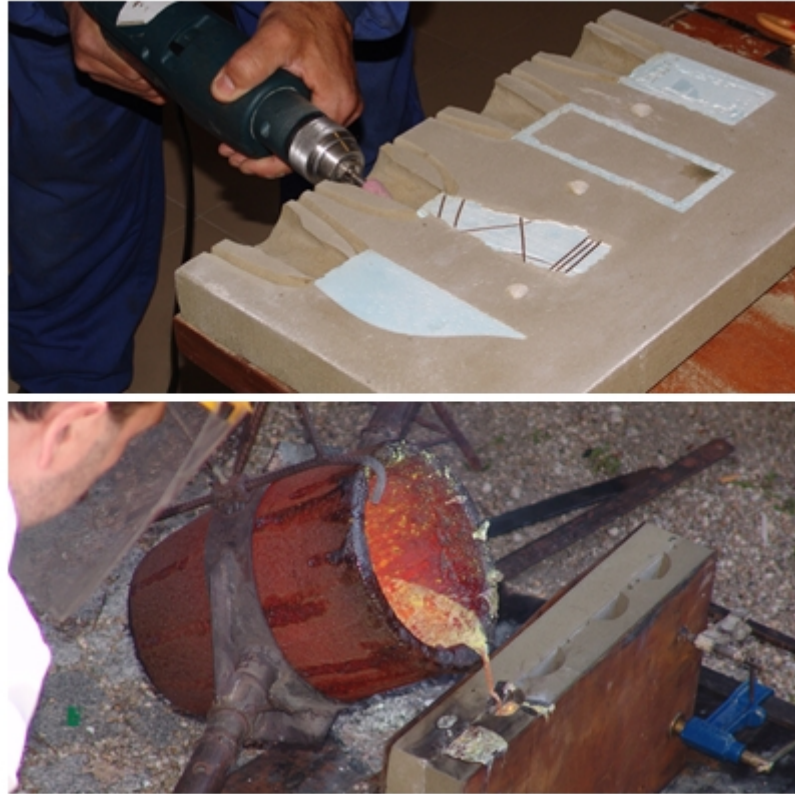
Fig.3.22. la preparación del sistema de alimentación y vertido del metal fundido sobre el molde cerrado.
