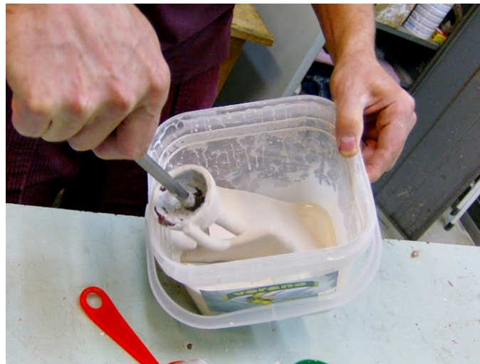
Fig. 3.7. La aplicación de varias capas de aglutinante y material refractario al modelo de cera. Imagen adaptada de: http://tallerdefundicionygalvanoplastia.blogspot.com/2012/02/fundicion-con-cascara-ceramica.html
