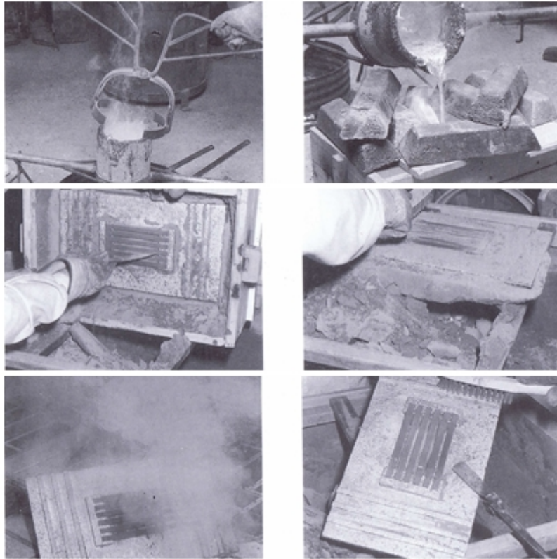
Fig. 3.17. El vertimiento del metal fundido, el desmolde de las cajas y la limpieza de la pieza. Imagen adoptada de Sorroche Cruz (1994).
