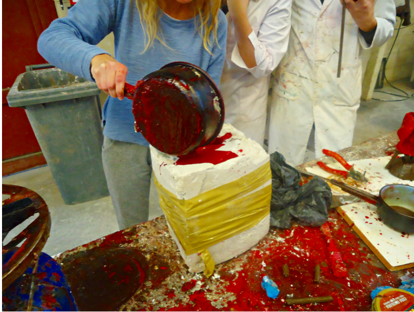
Fig. 3.2. Método colada directa de cera por llenado completo al molde. Fuente: Elaboración propia
