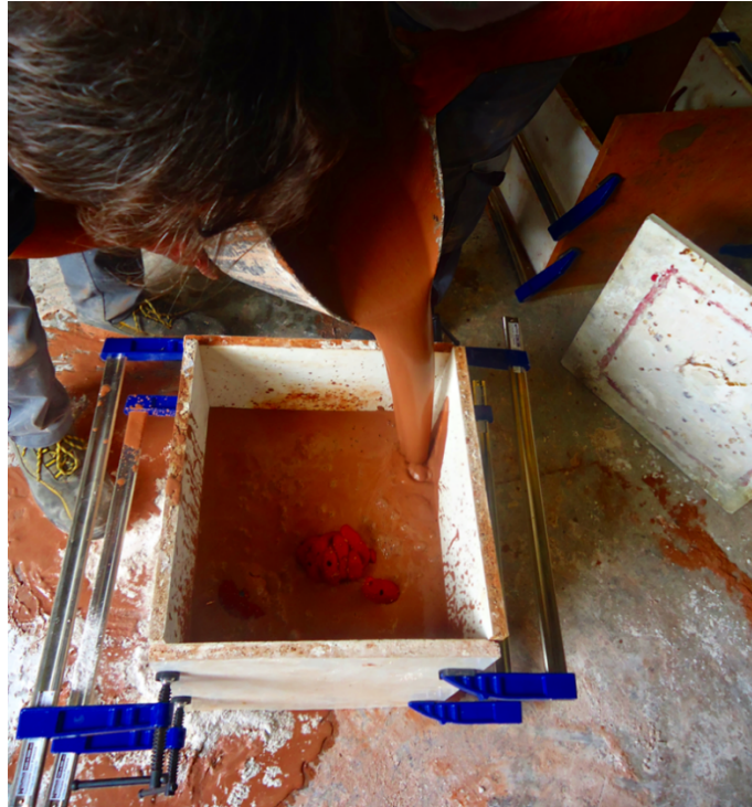
Fig. 3.4. Verter la mezcla de la chamota en una caja. Fuente: Elaboración propia
