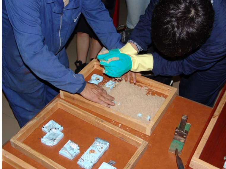
Fig.3.20. Vertido de la arena aglutinada sobre la pieza.
