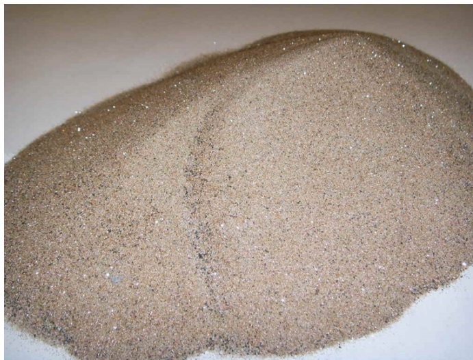
Fig. 3.11. Arena de zirconio. Imagen tomada de: https://zapetrochem.en.ecplaza.net/products/zircon-sand_3116709
