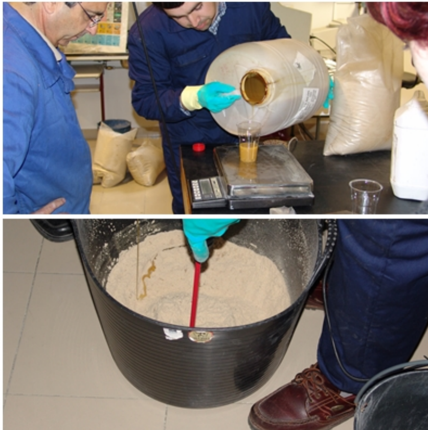
Fig.3.19. La preparación de la mezcla de la arena de sílice con el catalizador y la resina
