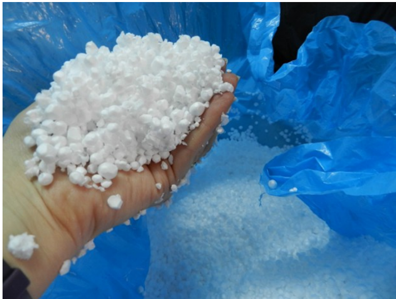
Fig.3.23. granos de poliestireno expandido. Imagen tomada de: http://www.arqhys.com/usos-del-poliestireno-expandido.html
