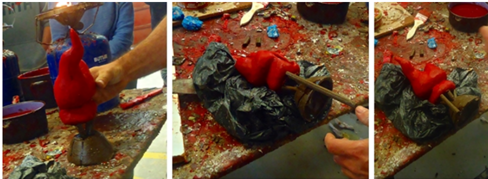
Fig. 3.3. Preparación de los bebederos y la salida de gases. Fuente: Elaboración propia
