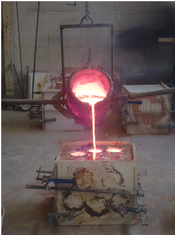
Fig. 3.5. La colada del metal fundido en el vaciado que ha dejado la cera eliminada del molde de chamota. Fuente: Elaboración propia
