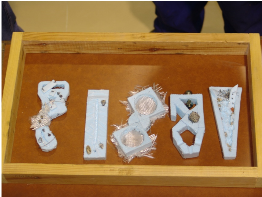
Fig.3.18. La colocación de los modelos desechables en un marco sobre un tablero.
