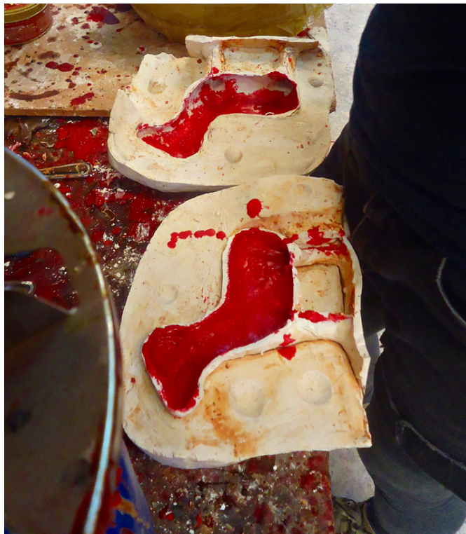
Fig.3.1. Método vaciado de estratificado de cera por estampación o impresión. Fuente: Elaboración propia
