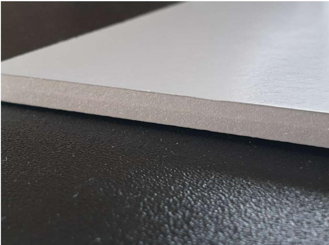
Figura 30. Vista de la sección de una lámina de 30 mm de cartón pluma mostrando su núcleo y sus dos superficies.
