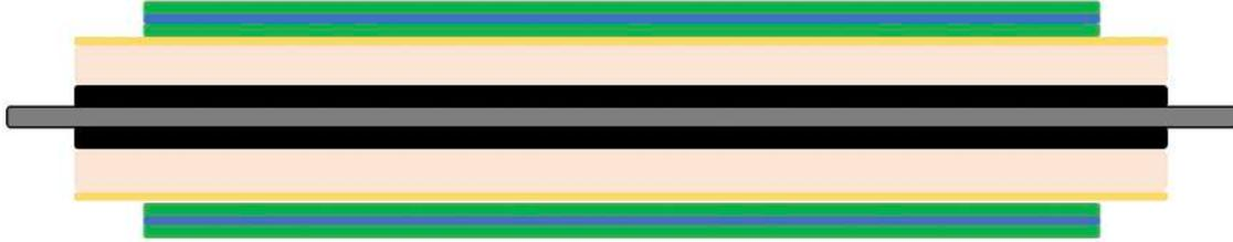
Figura 40. Esquema de la sección longitudinal del montaje del rulo con el textil arrollado intercalando Tyvek® entre sus capas
