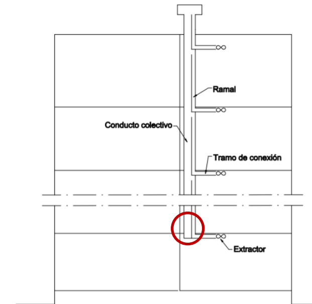
Esquema adecuado para ventilación de viviendas y extractor de cocinas Fuente: Figura derecha 3.5. DB-HS3
