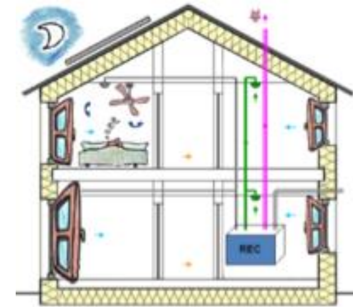
Ventilación natural con extracción mecánica Fuente: Contart, Rafael Gracia Aldaz
