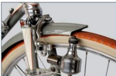
Otros dispositivos aprovechan el movimiento para generar una corriente continua de electricidad mediante inducción electromagnética
