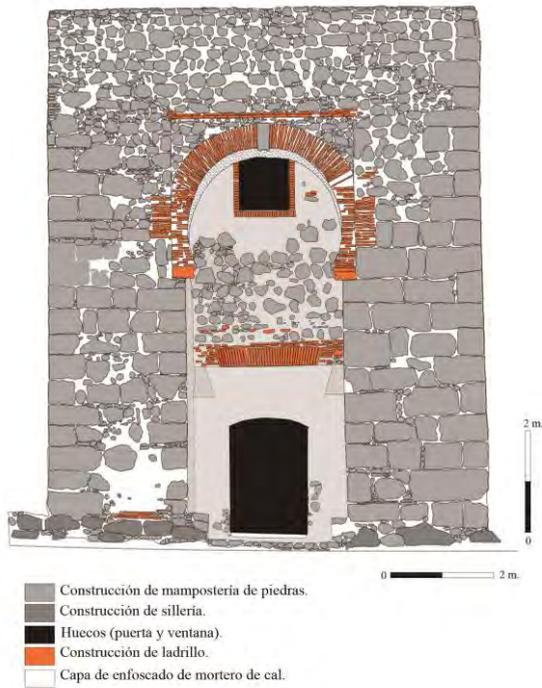
Fig. 6.- Alzado suroeste exterior de la puerta de Málaga.
