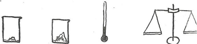
Un trozo pequeño de hielo y otro trozo más grande. Ambos se colocan en sendos recipientes. Se mide la masa de ambos recipientes una vez introducido el hielo. Se pregunta sobre la temperatura y la masa en el proceso de fusión del hielo en ambos recipientes. Se mide la masa de ambos recipientes, así como su temperatura, durante el proceso.
