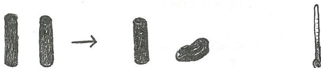
Dos barras de plastilina. Medida de la temperatura. Una de ellas se deforma con la mano. Predicción de la temperatura de la deformada. Comprobación.
