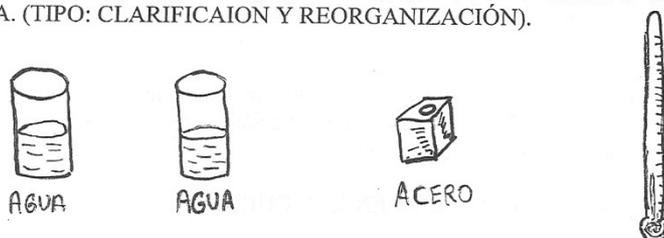
Vaso de agua fría. Vaso de agua caliente. Acero enfriado en el congelador. Medida de la temperatura de cada uno. Predicción de los posibles cambios al cabo de un cierto tiempo cuando se dejen en la mesa. Medida de la temperatura pasado un cierto tiempo. Medida final de la temperatura. Clarificación y reorganización.
