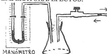
Construcción del montaje experimental. Calentamiento con la mano del erlenmeyer. Control de la expansión mediante la llave. Previsión de los resultados en un caso o en otro. Verificación.
