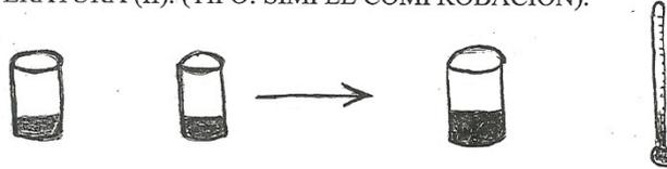
Dos recipientes con iguales cantidades de agua, uno con agua coloreada de azul y el otro de rojo. Se pregunta sobre la temperatura de ambos. Se comprueba experimentalmente la respuesta. Se mezclan ambos recipientes y se procede como antes.
