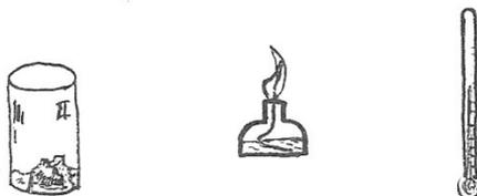
Hielo fundente en un recipiente. Medida de la temperatura. Predicción de la temperatura de la mezcla, mientras siga fundiéndose el hielo, cuando se introduzca la llama de un mechero. Comprobación experimental. Clarificación.
