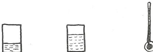
Dos recipientes con distintas cantidades de agua. Se mide la temperatura de ambas. Se pregunta si la temperatura del agua, en cada vaso, será diferente una vez que esté hirviendo. Se lleva a ebullición el agua de ambos recipientes. Comprobación experimental.
