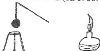
Anillo de Gravesande. Peso de la bolita de acero. Paso de la misma por el anillo. Calentamiento de la bolita. Predicción sobre el paso de la misma. Peso de la bolita. Comprobación experimental. Interpretación.
