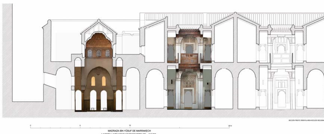
Figura 185. Sección por el frente oriental ( mīdā'a y núcleos secundarios).
