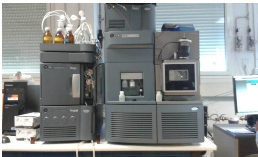
Figura 16. Cromatógrafo líquido de ultra alta resolución y espectrómetro de masas Acquity UHPLC BEH en tándem con espectrómetro de masas Waters Xevo TQ-S (Waters Co., Milford, MA).
