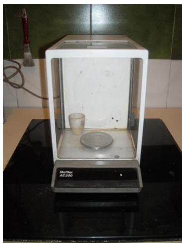
Figura 14. Balanza de precisión Mettler AE 200 para pesaje de todos los reactivos.
