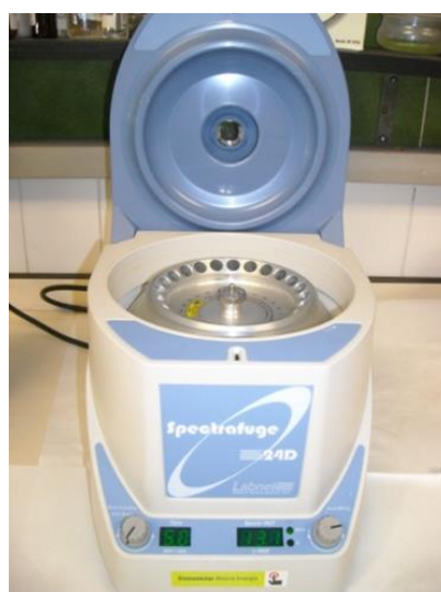
Figura 9. Centrífuga Labnet Spectrafuge 24D para desproteínizar el plasma.
