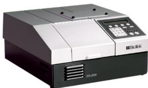
Figura 20. Lector con multi-detección de fluorescencia de microplacas FLx800TM (BioTek).
