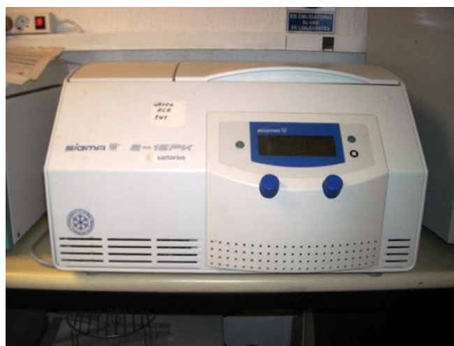
Figura 6. Centrífuga Sigma 2-16PK Sartorius, utilizada en el proceso de obtención del plasma.
