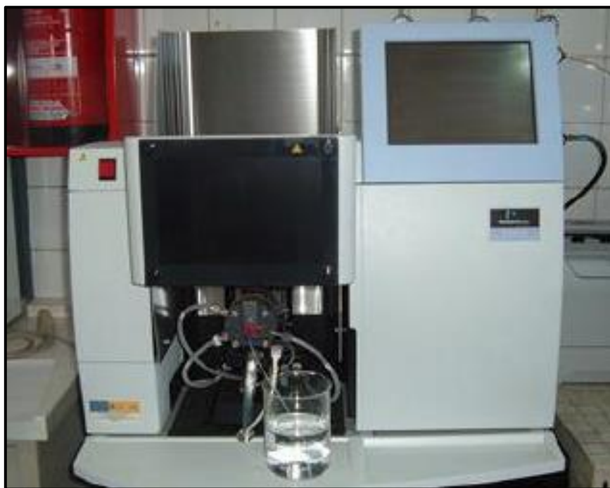
Figura 1.4. Espectrofotómetro de absorción atómica PerkinElmer (AAAnalyst 200)
