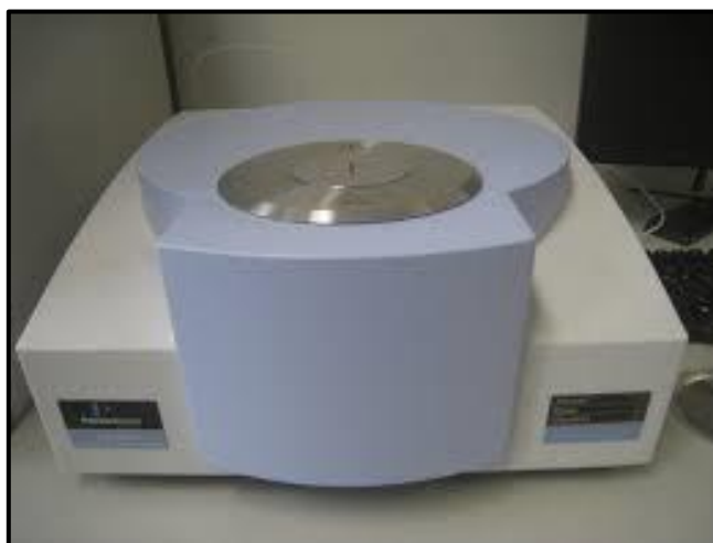
Figura 2.3. Termobalanza Perkin Elmer (modelo STA 6000).
