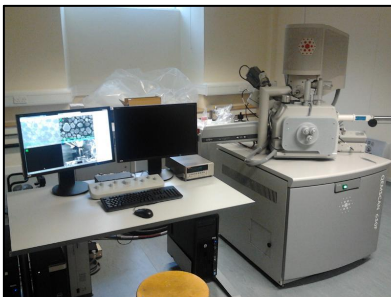
Figura 4.4. Equipo QuemScan650F, Microscopía Electrónica de Barrido (SEM).
