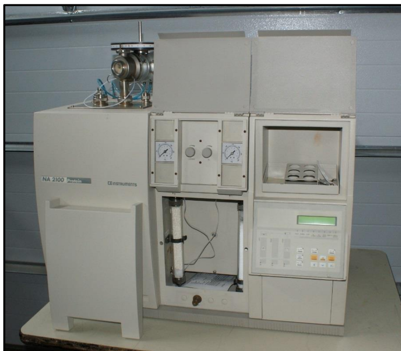
Figura 2.1. Analizador elemental Fison's Instruments EA 1108 CHNS.
