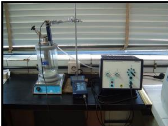
Figura 2.2. Bomba calorimétrica modelo Phywe LEC-02.
