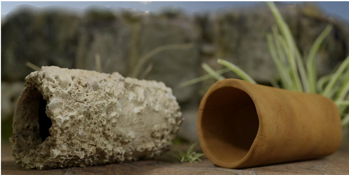
Figura 4.150. Reconstrucción con acabado mimético y recreación llevada a cabo en Blender a partir del modelo fotogramétrico de la pieza N° 52. Modelo original (izquierda) y reconstrucción basada en la sección de la parte visible (derecha).
