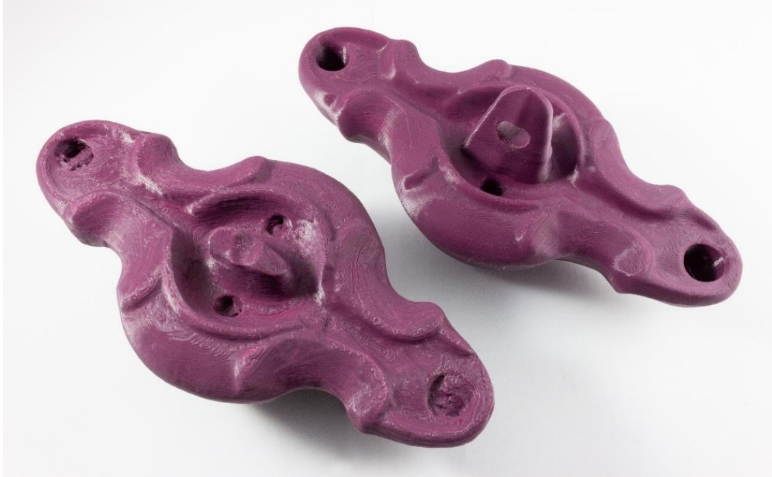
Figura 4.205. Réplicas en ácido poliláctico (PLA) llevadas a cabo a partir del modelo fotogramétrico original (izquierda) y el modelo reconstruido con acabado mimético (derecha) de la pieza N° 71. La impresión 3D se llevó a cabo mediante una impresora Creality Ender 3 pro.
