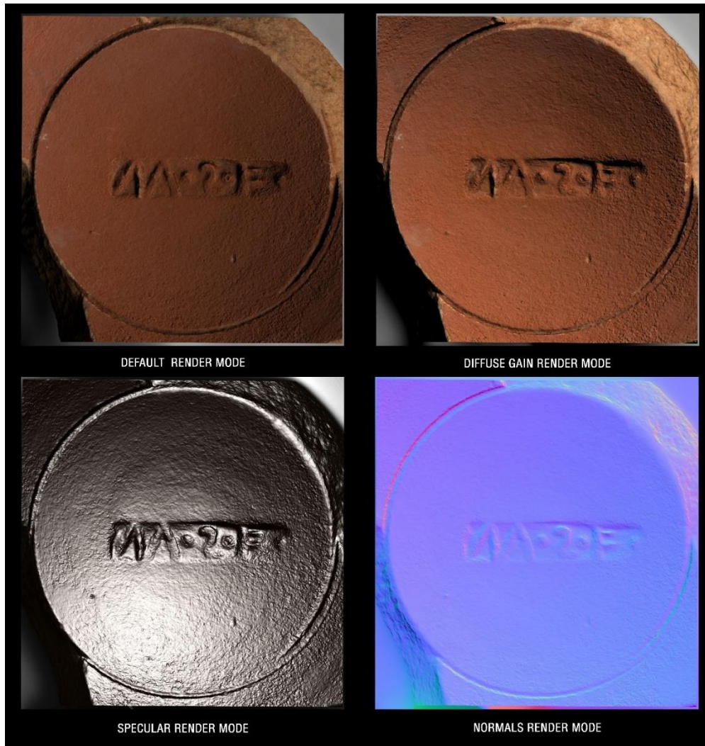
Figura 4.72. Montaje con las capturas obtenidas en RTIViewer sobre el modelo de Polynomial Texture Mapping (.ptm) de la pieza Nº 31 de terra sigillata hispánica procedente del complejo alfarero de Los Villares de Andújar (Jaén, España). En él se muestran algunos de los modos de renderizado con los que permite trabajar el software de forma interactiva.
