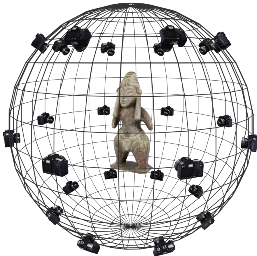
Figura 3.16. Sistema de alturas y grados de inclinación de cada uno de los círculos que componen un escaneo fotogramétrico estándar.
