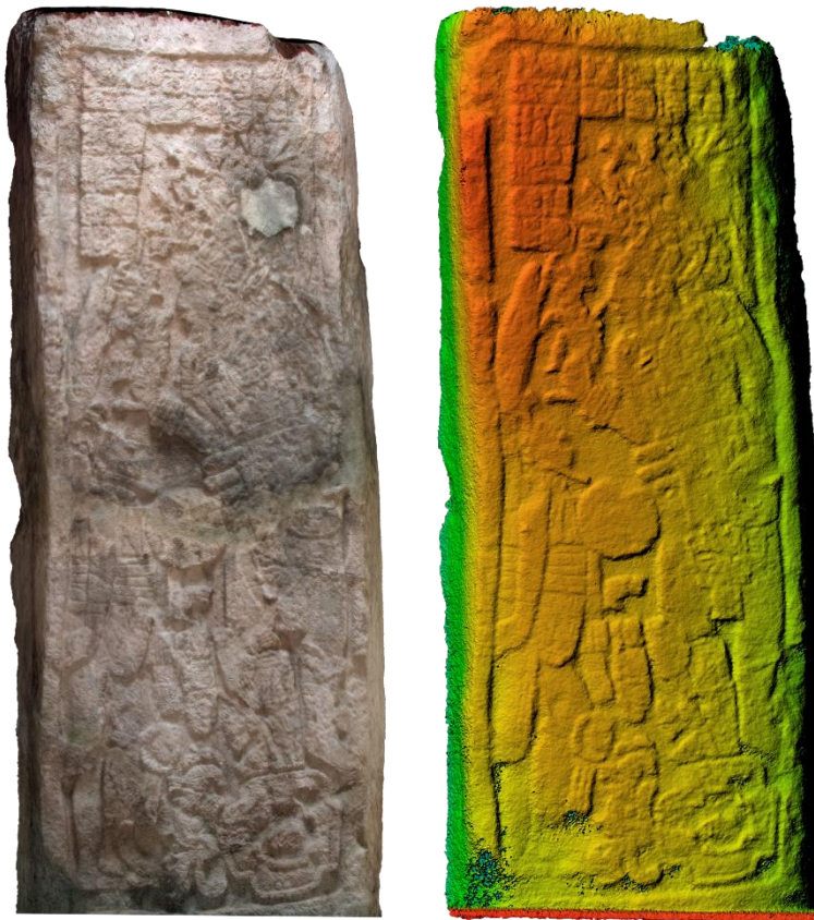
Figura 3.75. Ortofotografía (izquierda) y Modelo Digital de Elevaciones (derecha) llevado a cabo en el software fotogramétrico Agisoft Metashape sobre el modelo fotogramétrico de la estela N° 2 del yacimiento maya de Edzná (Campeche, México).
