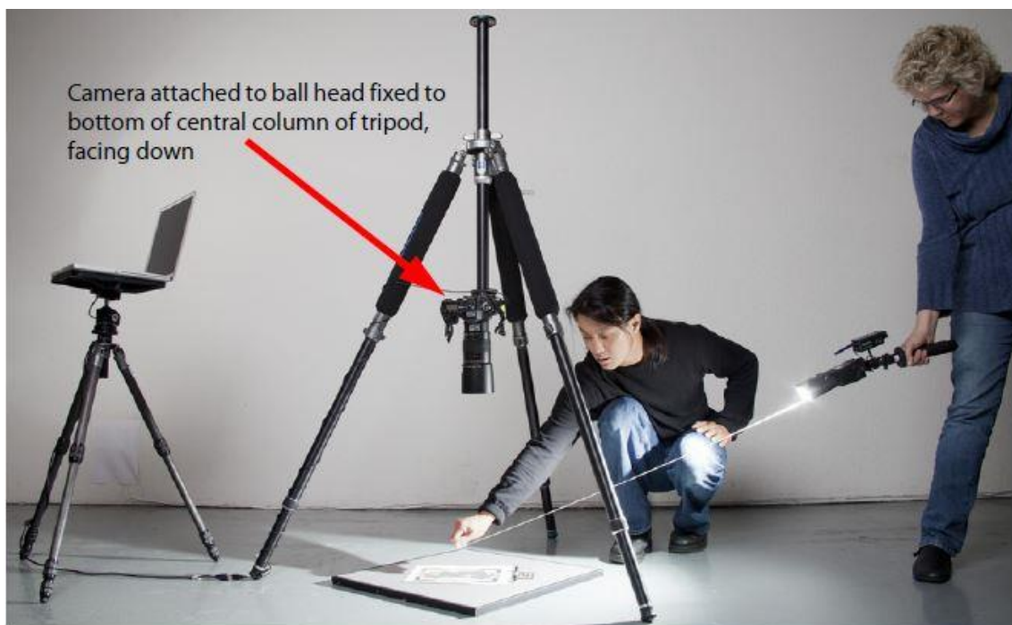
Figura 3.49. Método tipo Highlight de captura de imágenes para Reflectance Transformation Imaging. Imagen obtenida de: Método tipo Highlight de captura de imágenes para Reflectance Transformation Imaging . Imagen obtenida de: (AA.VV., 2013: 9).
