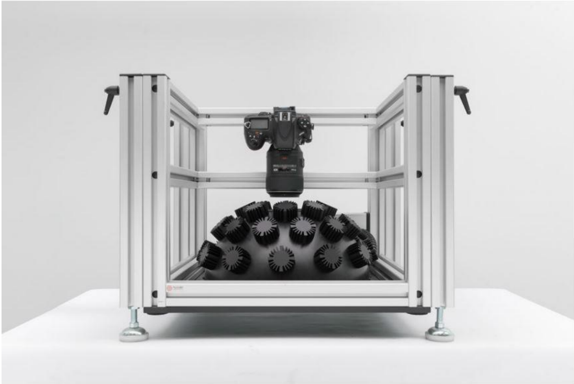
Figura 3.48. Método tipo Domo de captura de imágenes para Reflectance Transformation Imaging . Este emplea una cúpula o domo compuesta por decenas de luces y cuyas posiciones y ángulo de incidencia son siempre las mismas y están recogidas por un dispositivo informático. Imagen obtenida de: (Dedík y Minaroviechh, 2017: 598).
