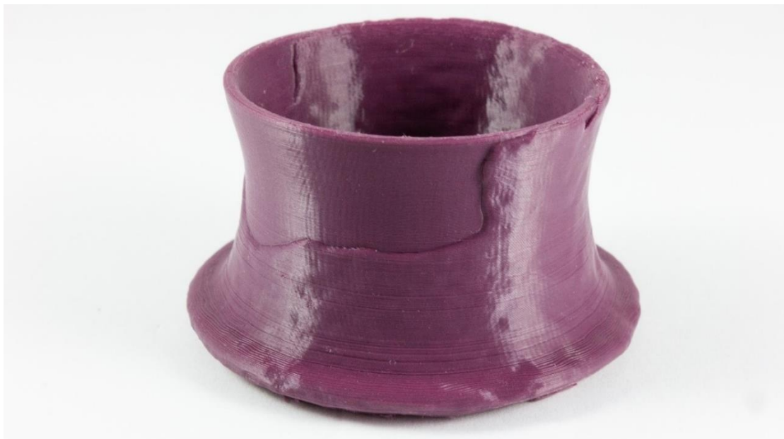
Figura 4.201. Réplica en ácido poliláctico (PLA) llevada a cabo a partir del modelo fotogramétrico con prótesis no mimética de la pieza N° 70.
