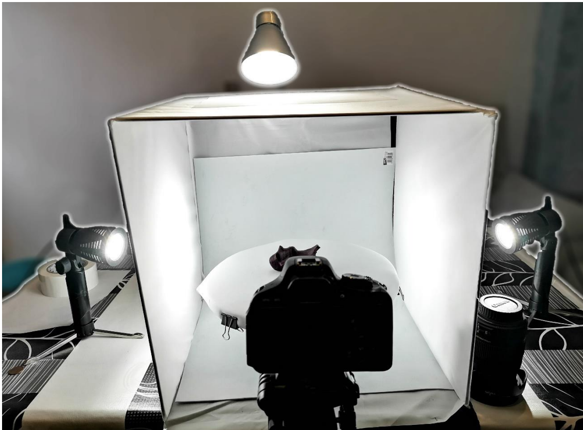
Figura 3.13. Equipo de fotografía e iluminación preparados para llevar a cabo la fotogrametría de laboratorio.
