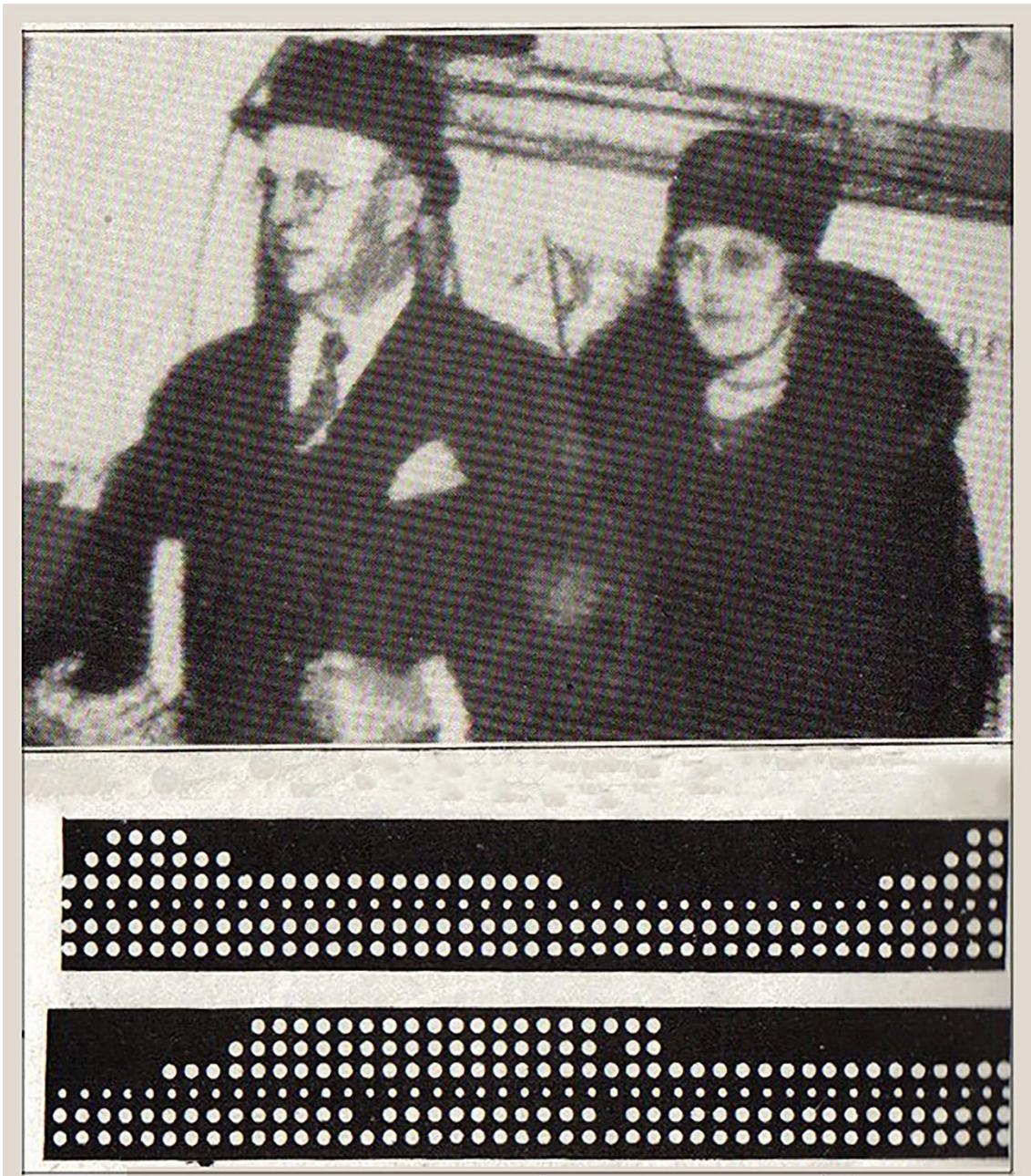
Figura 3.76. Primera imagen digital ya decodificada enviada desde Londres a Nueva York en 1921 (parte superior). Muestras de la cinta Baudot que codificaba la información para para transmitir imágenes por sistema Bartlane (parte inferior). Montaje propio a partir de las fotografías extraídas online (Ramis, 2019: en línea).
