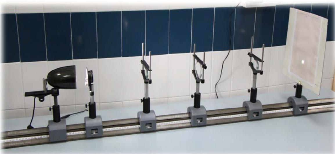
Figura 5.8. Disposición real de los elementos del frontofocómetro de proyección.
