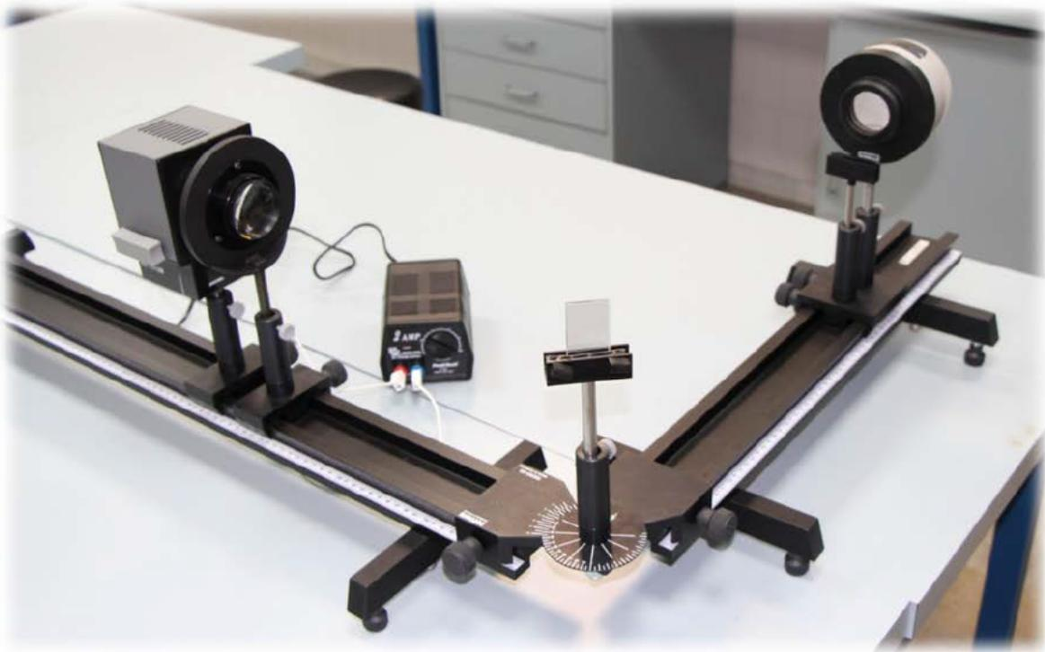
Figura 1.2. Retinoscopio de banco y disposición de los elementos sobre el banco óptico.
