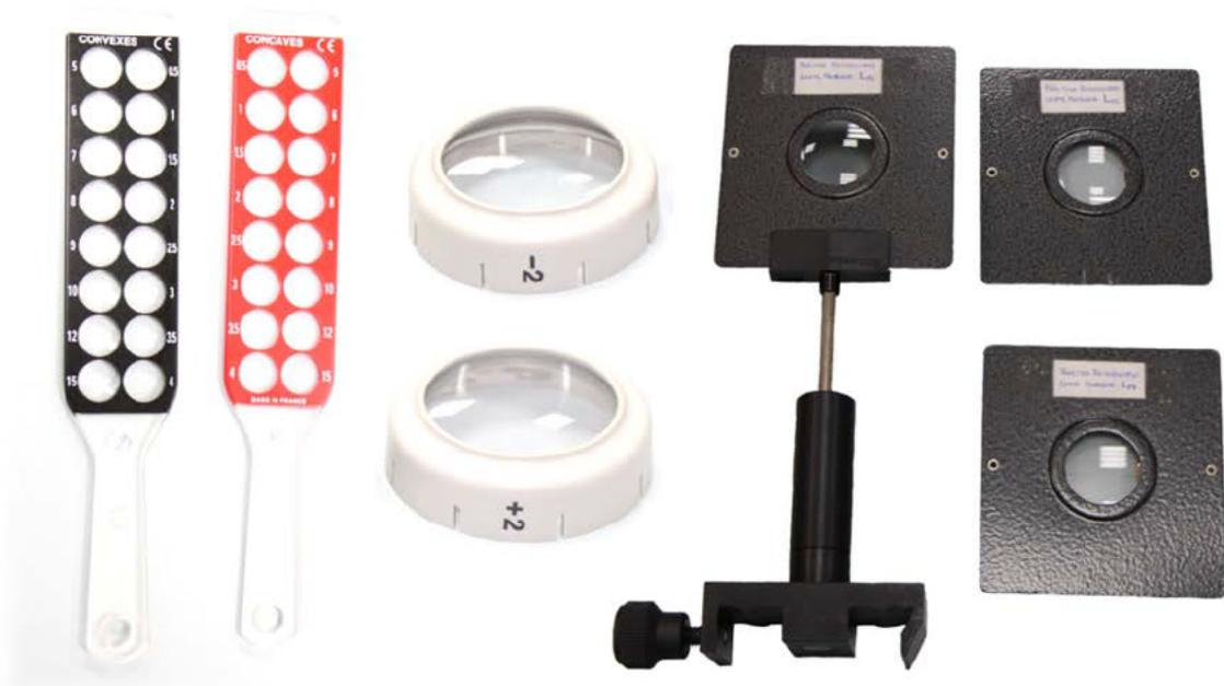
Figura 1.3. A la izquierda, reglillas de esquiopía. En el centro, lentes de  $-2D$  y  $+2D$  que se pueden acoplar al ojo artificial. A la derecha, jinetillo y diferentes portalentes con las lentes problema.
