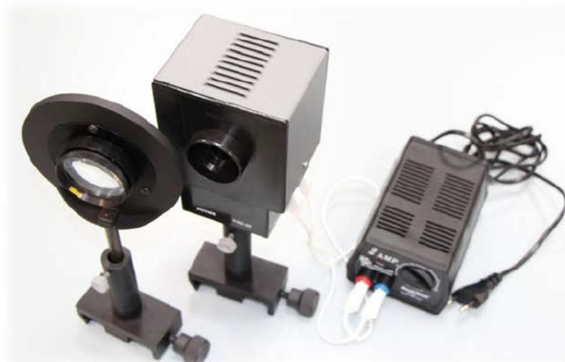
*Fuente luminosa, condensador y fuente de alimentación.
