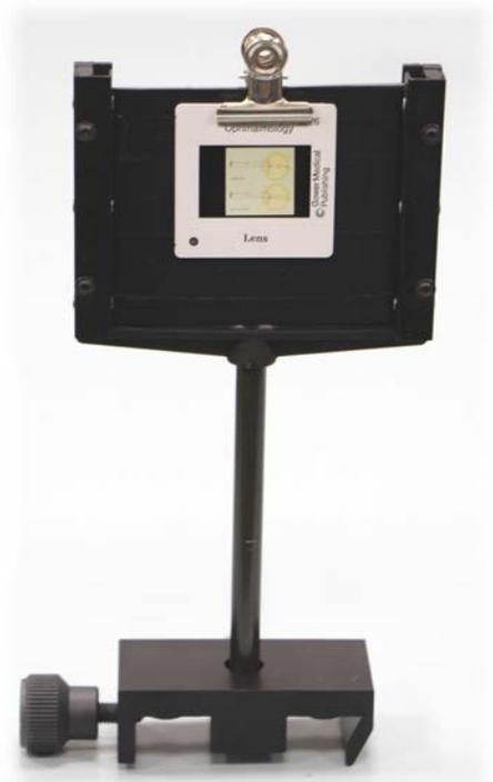
*Figura 4.3. Objeto auxiliar para encontrar la imagen de la hendidura sobre la pantalla.*
