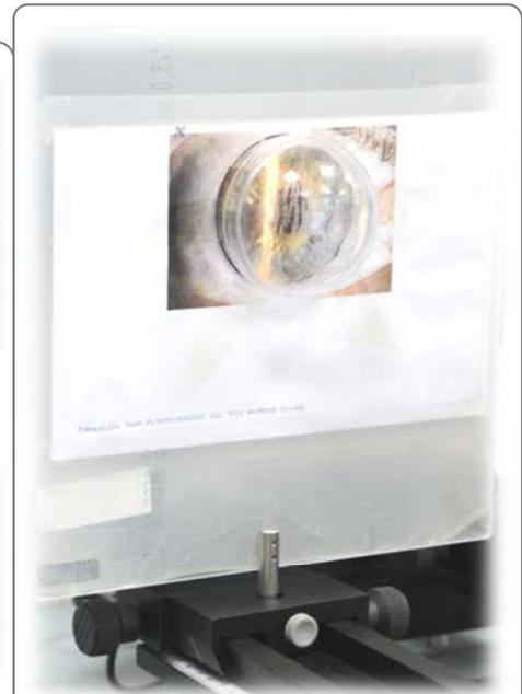
*Figura 4.5.b. Pantalla con fotografía de un ojo y hemiesfera transparente que simula la córnea.*
