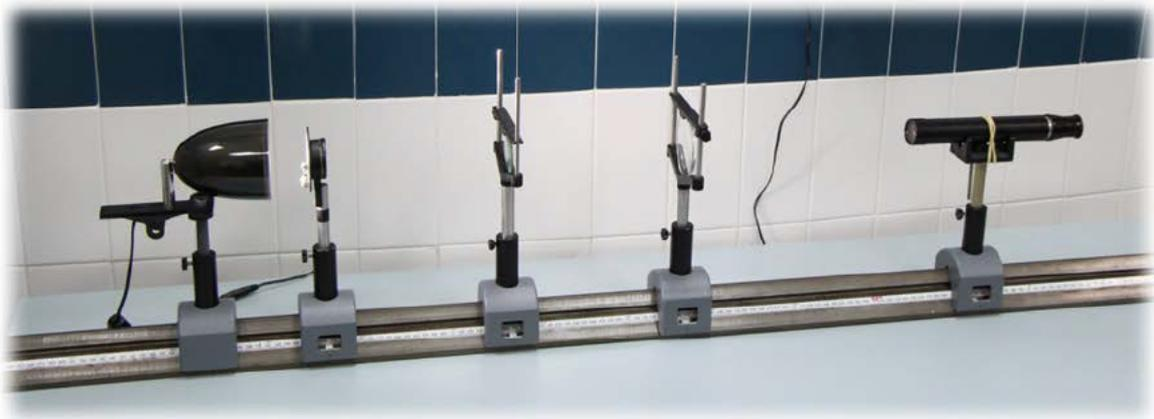
Figura 5.7. Disposición real de los elementos del frontofocómetro de observación.
