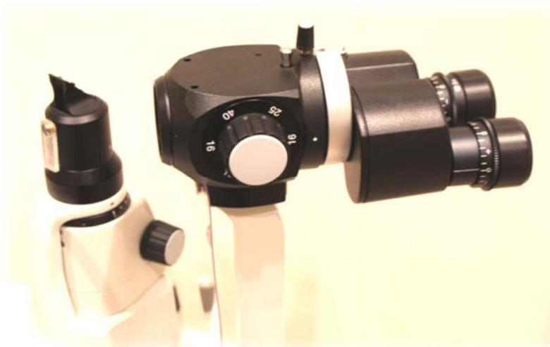
*Figura 4.1.c. Detalle del microscopio (sistema de observación) de un biomicroscopio comercial.*
