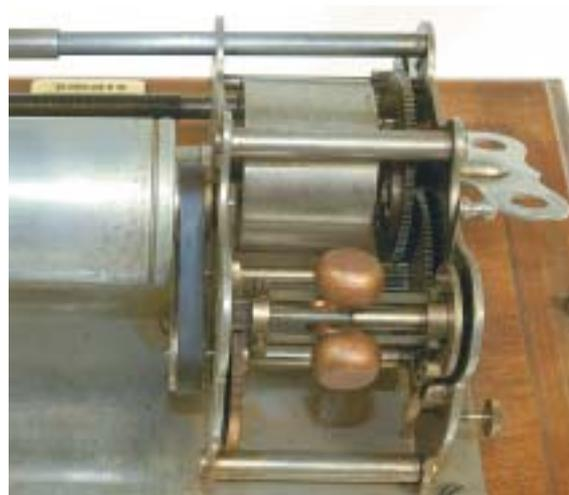
45. Mecanismo exterior de fonógrafo - motor de cuerda y control de velocidad centrífuga - CDMA 533
