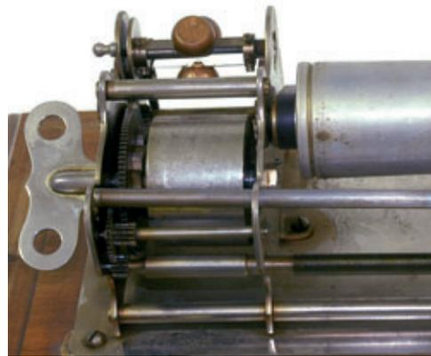
142. Mecanismo exterior -fonógrafo, motor de una cuerda accionado por una llave, nº cat. 52.
