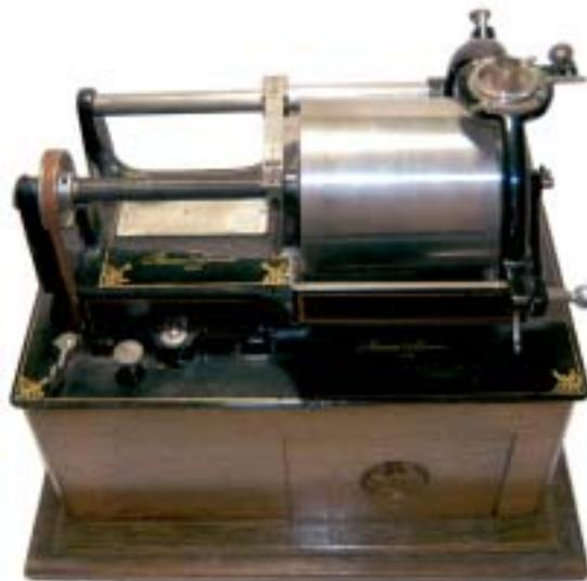
**Descripción:** Fonógrafo Edison –modelo Concierto-. Presenta caja de madera de forma rectangular con motor interior de tres cuerdas, cubierta de metal y tapa de vuelta que reposa en la base de la caja con asa y cierre metálico, por presión, a ambos lados.
