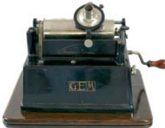
**Descripción:** Fonógrafo Edison -modelo Gem-. Tiene caja de metal lacada en negro sobre tabla de madera con motor interior, tapa de vuelta con asa y cierre de tornillos a ambos lados.
