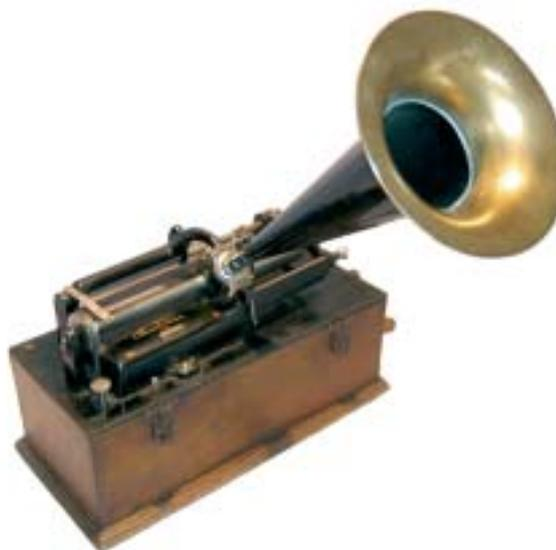
**Descripción:** Caja rectangular de madera con motor interior, cubierta metálica esmaltada en negro que presenta restos de cenefa, Marca Registrada y firma de Edison en dorado, y tapadera de vuelta con asa.
