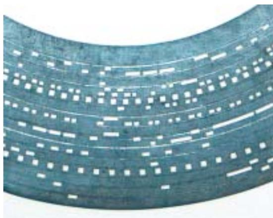
**Descripción:** Disco perforado de metal, sin pestañas, con forma anular, de 33,5 cm. de diámetro, para “organillo”. Fabricado por la casa alemana Phoenix, en 1900, para su organillo n° 37, modelo “B” de 24 lengüetas dobles de acero, con un total de 48 lengüetas.
