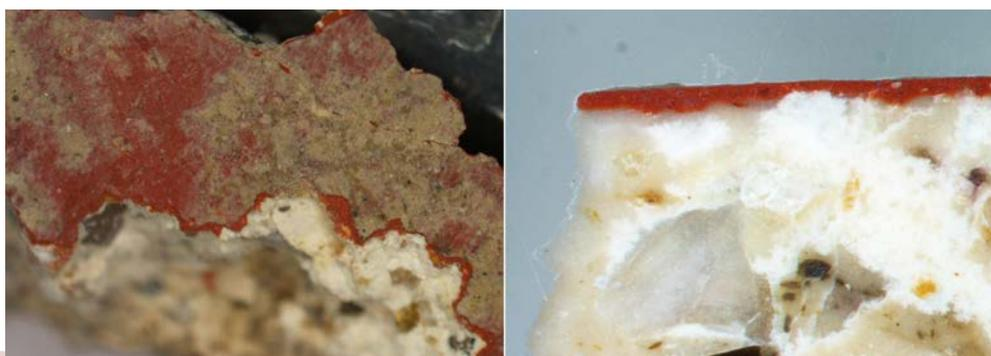
**Figura 52:** Muestra R7 Rojo. Imagen tomada mediante microscopía estereoscópica en la que se aprecian dos estratos de rojo (Izquierda). Imagen de la probeta pulida en la que sólo se aprecia un estrato en la capa pictórica (Derecha).
