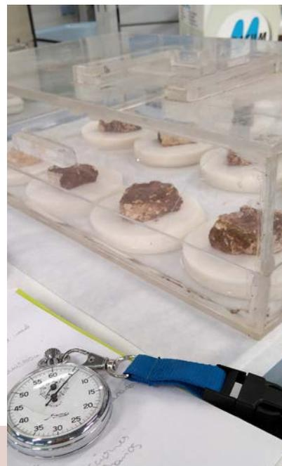
**Figura 9:** Realización del ensayo de absorción de agua por capilaridad.
