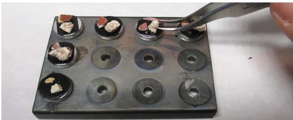
**Figura 10:** Preparación de muestras para el análisis mediante HRSEM.
