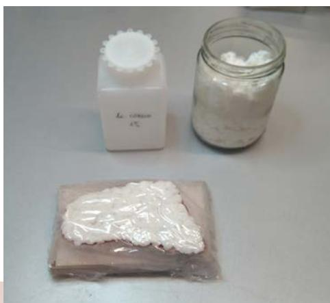
**Figura 80:** Fragmento 02 tratado con ácido cítrico y Arbocel BC 1000.
