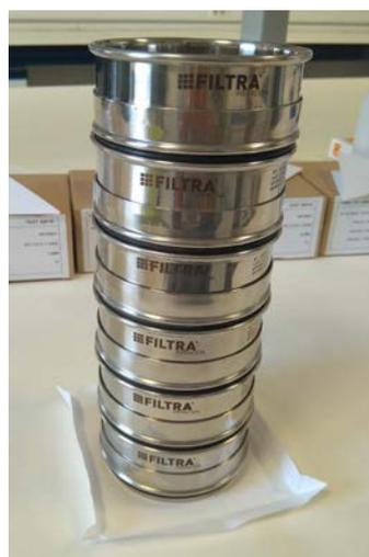
**Figura 3:** Tamizado de las muestras de mortero por vía seca.
