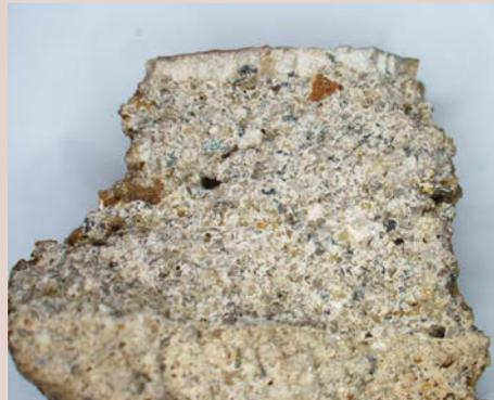
**Figura 71:** Muestra procedente de las pinturas murales de época romana de la excavación de Parque Infantil de Tráfico. Fotografía tomada mediante microscopía estereoscópica donde se aprecian los tres estratos de mortero.
