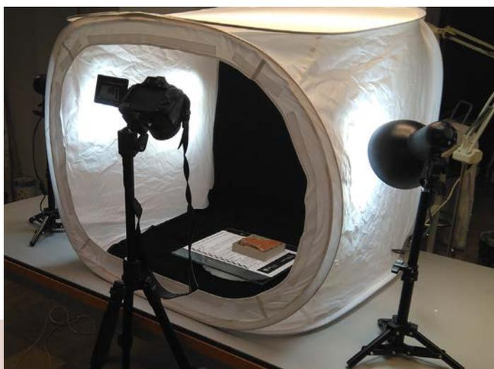
**Figura 6:** Toma de fotografías para la realización de los modelos fotogramétricos.
