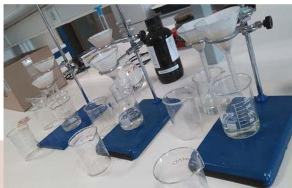
**Figura 4:** Filtrado de las disoluciones de las muestras de mortero para establecer la relación entre aglomerante y árido.
