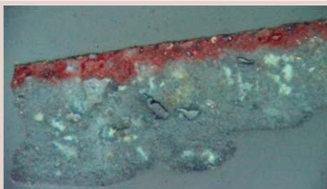
**Figura 78:** Muestra HRS2 Rojo preparada en lámina delgada y vista mediante microscopía óptica donde se aprecia la capa pictórica espatulada.
