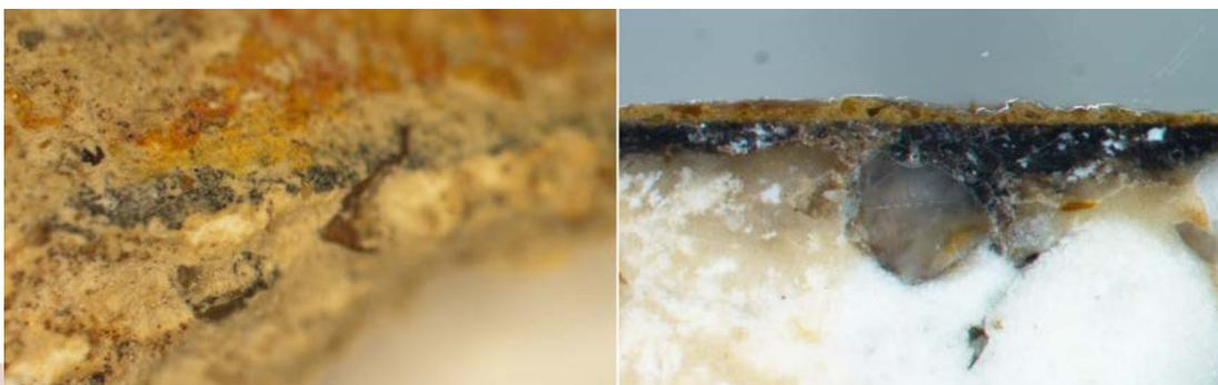
**Figura 54:** Muestra R15 Naranja. Imagen tomada mediante microscopía estereoscópica en la que se distinguen dos estratos de amarillo sobre fondo negro (Izquierda). Imagen de la muestra preparada como probeta pulida en la que solo se aprecia un estrato de color amarillo sobre fondo negro (Derecha).
