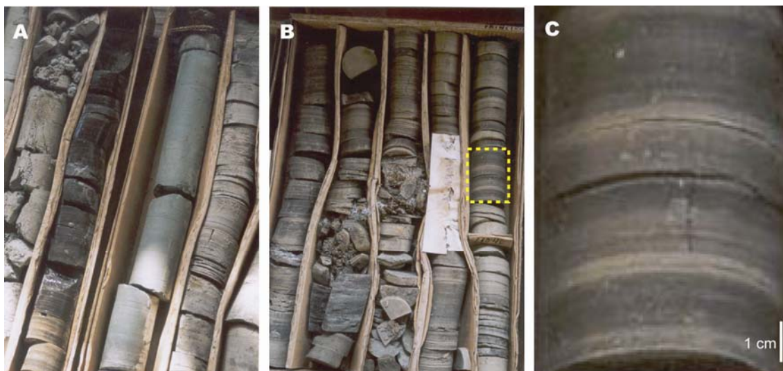
Fig. 3.15. Fotografías del sondeo RM-1. (A) Ciclicidad de orden métrico arcillas masivas (grises-verdes) – arcillas laminadas (obscuras); (B) Facies laminadas anóxicas; (C) detalle de las ritmitas en las facies laminadas (recuadro amarillo en B).
