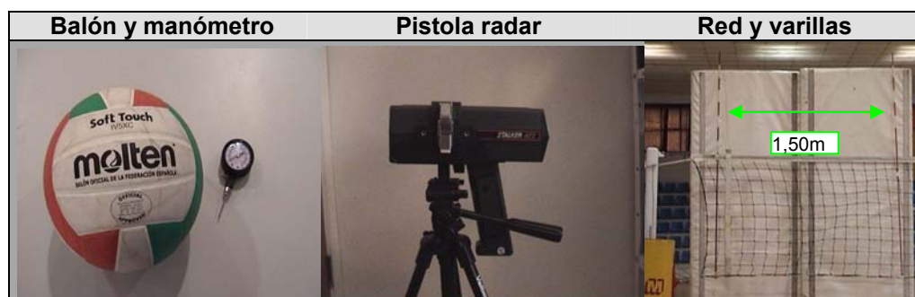
Figura II-3. Instrumental y material utilizado para el control de la velocidad del remate y del golpeo.
