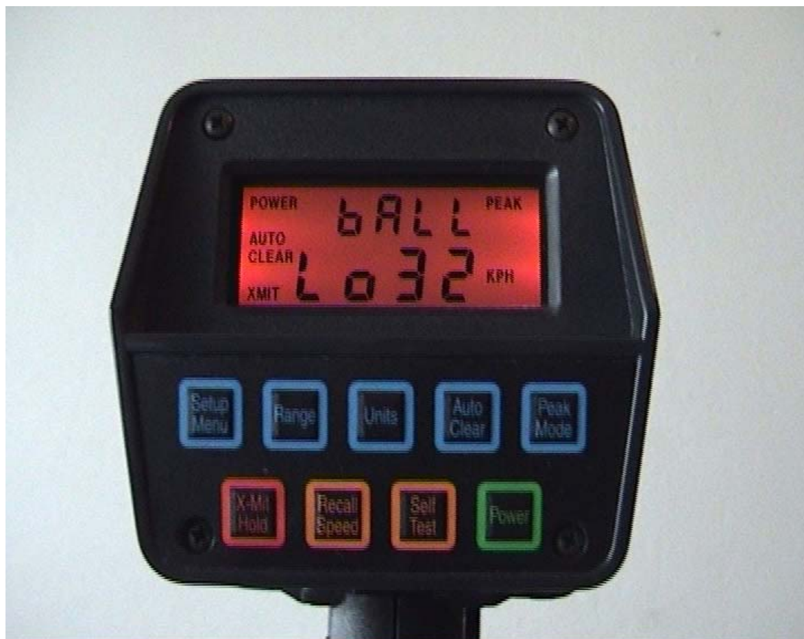
Pantalla de la pistola radar y opciones de programación.
