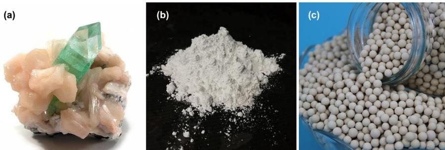
**Figura 1.7.** (a) Mineral estilbita. (b) Zeolita sintética 4A (utilizada en detergentes, entre otras aplicaciones) en forma de polvo y (c) esferas.
