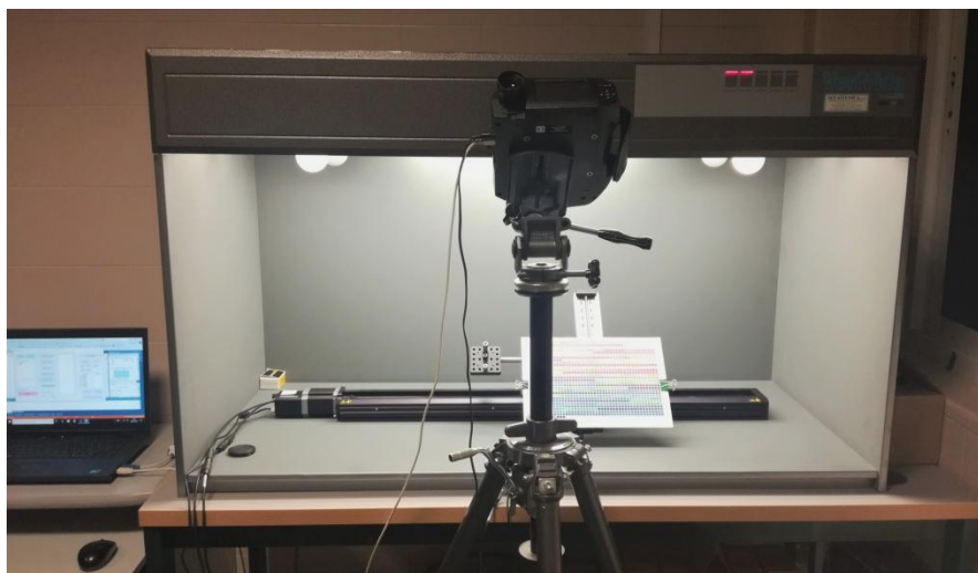
Figura 1. Módulos automatizados de desplazamiento dentro de la cabina de iluminación. Espectrorradiómetro y ordenador usados en el montaje. Autora: Ana Belén López Baldomero.
