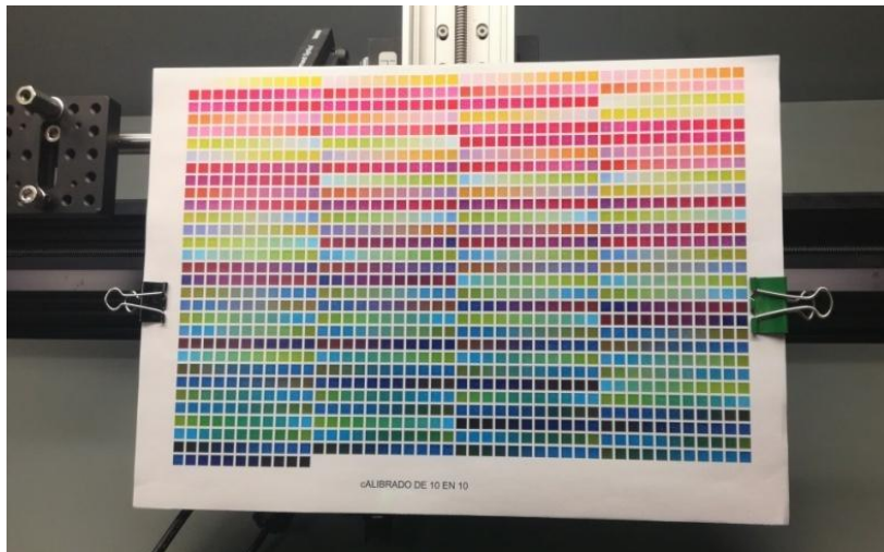
Figura 3. Patrón con 1331 muestras colocado sobre el soporte a 45°. Autora: Ana Belén López Baldomero.
