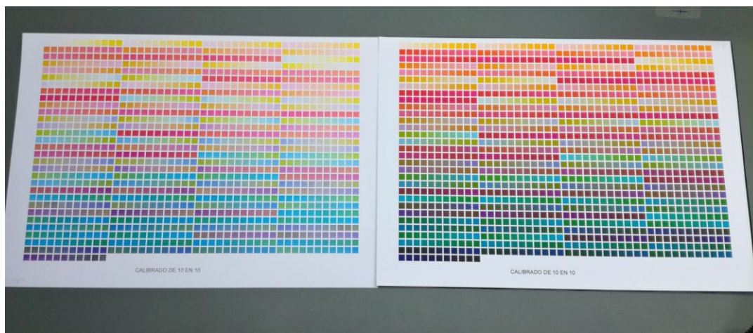
Figura 32. Patrón de 1331 muestras impreso en papel de marca blanca con impresora láser (izquierda) y con impresora de inyección de tinta (derecha). Autora: Ana Belén López Baldomero.
