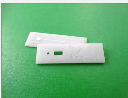
Dispositivo cargado con los reactivos y membrana de separación de células formes
